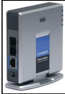
**Figura 23:** Adaptador analógico. **Fuente:** (“Adaptador,” 2011)
