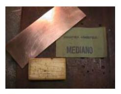
Una vez cortado el trozo a utilizar lijar los bordes tanto de la cara de cobre como de la otra a fin de quitar las rebabas producidas por el corte. Con la ayuda de un taco de madera es más fácil de aplicar la lija.
