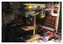
Un taladro de banco es de gran ayuda sobre todo para cuando son varios agujeros. Para los orificios de resistencias comunes, capacitores y semiconductores de baja potencia se debe usar una mecha (broca) de 0.75mm de espesor. Para orificios de bornes o donde se suelden espadines o pines una de 1mm es adecuada. Aquí será de suma utilidad atinarle al
