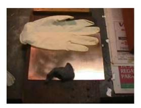
Como se ve en la foto es conveniente utilizar guantes de latex, del tipo utilizado para inspección bucal, para evitar que la grasa de los dedos tome contacto con el cobre. La lana de acero debe ser frotada sobre la cara de cobre y preferentemente dando círculos, para facilitar la adherencia tanto de los Pads como de la tinta del marcador.
