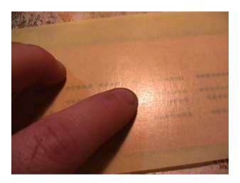
Si por error se aplicó un dibujo que no debía estar se lo puede quitar fácilmente raspándolo con un cortante filoso. No hay que preocuparse porque donde se pasó el cortante quede raspado, puesto que el cobre no quedará en esa zona no nos interesa entonces como este antes de ser atacado.
