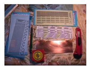
Para este paso requeriremos un marcador fino indeleble, uno grueso, un lápiz blando (mina B), una o varias plantillas Logotyp de islas (esto depende de la cantidad de contactos del circuito así como del tipo de islas requeridas). Ambos marcadores deben ser de tinta permanente al solvente. Hasta ahora el mejor que hemos usado es el edding 3000.
