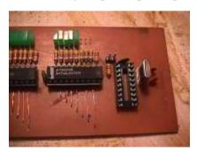
En la foto se observan puentes de alambre, resistencias, capacitores, zócalos para circuitos integrados, algunos diodos LED y un cristal.
