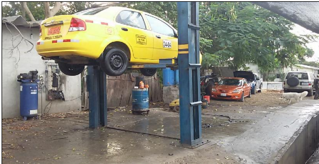
Imagen N° 5 Vehículo en Elevador para Limpieza de Estructura
