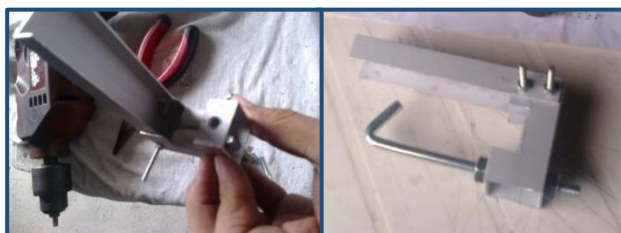
Figura 88: Colocación de pernos de ajustes.
