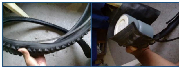
Figura 97: Recubrimiento de las bases de las ruedas con caucho de bicicleta.
