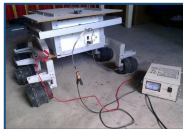
Figura 118: Conexión de carga de batería.
