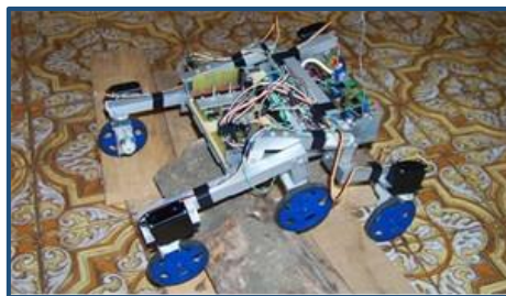
Figura 5: Robot rocker bogie rover para desplazamiento: picaxe.com
