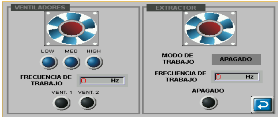
Figura 34: Pantalla "Control de sistema de ventilación". Elaborado por el autor.
