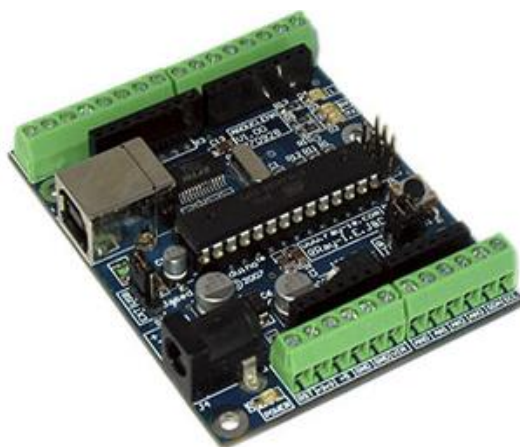
Figura 4: Placa de Arduino para conversión D/A: Arduclema
