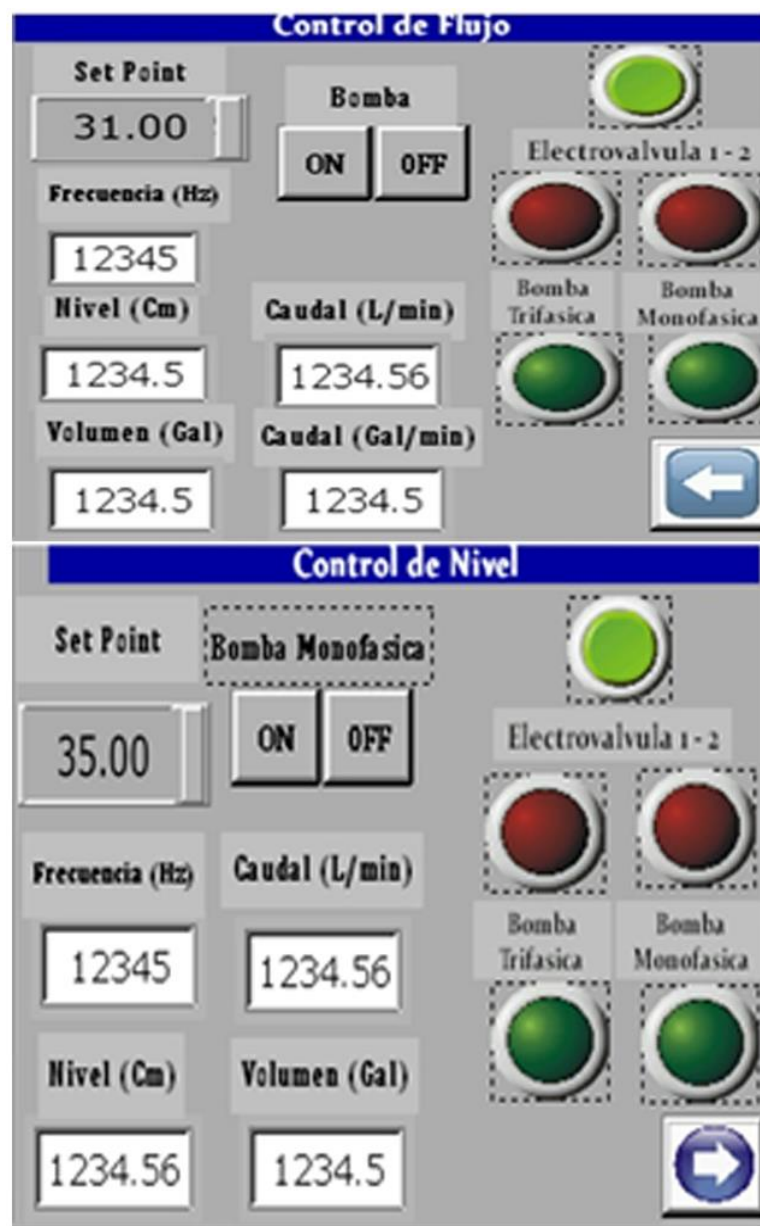
Figura 37: Asignación de variables para comunicación PLC-Pantalla HMI.
