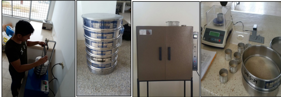
Figura 3.29. Tamizadora - Tamices - Horno – Balanza para análisis granulométrico
