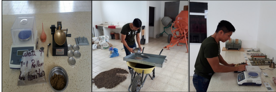
Figura 3.38. Balanza – Copa de Casa Grande para ensayos de límites
