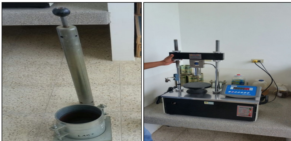
Figura 3.22. Martillo metálico – Prensa hidráulica para ensayo C.B.R
