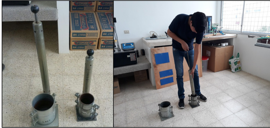
Figura 3.9. Martillo y cilindro metálico (grande para Proctor modificado y el pequeño para Proctor estándar)
