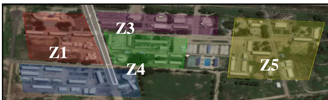
Figura 22: Zonas para distribución de red GPON.
