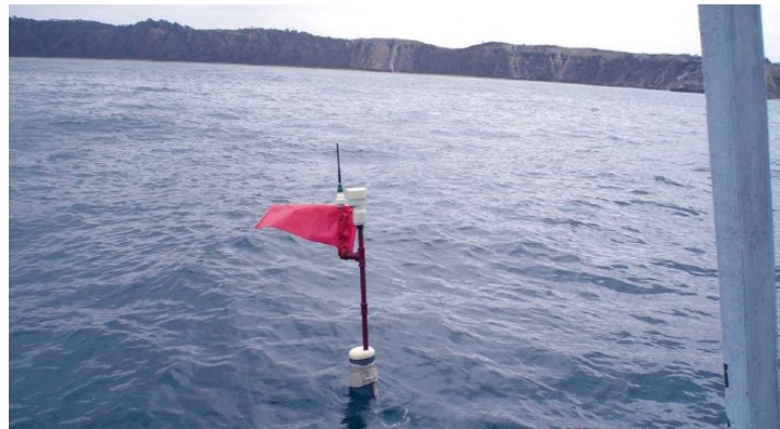
Fig.5: Derivador basado en GPS, monitoreado por Radio Fuente: (A. & Chacón D., 2009)
