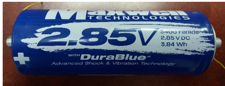
Fig.9: Supercapacitor Maxwell 2.85V Fuente: Elaborado por el Autor
