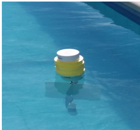
Fig.57: Prueba de hermeticidad del trazador
