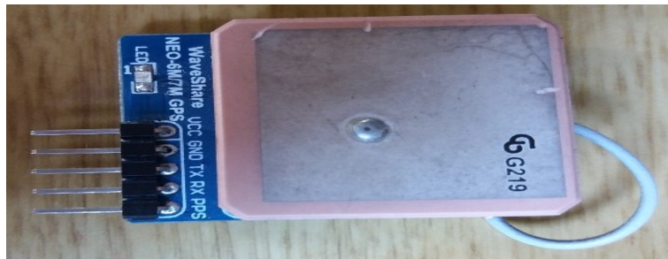
Fig.12: Gps Ublox Neo 6M pines de conexión
