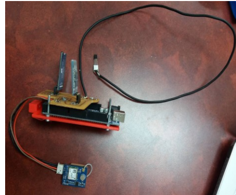
Fig.63: Arduino fijado al soporte Fuente: Elaborado por el Autor
