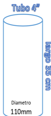
Fig.53: Dimensiones del tubo de 4''
