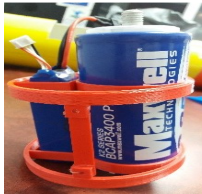
Fig.58: Soporte con batería adicional
