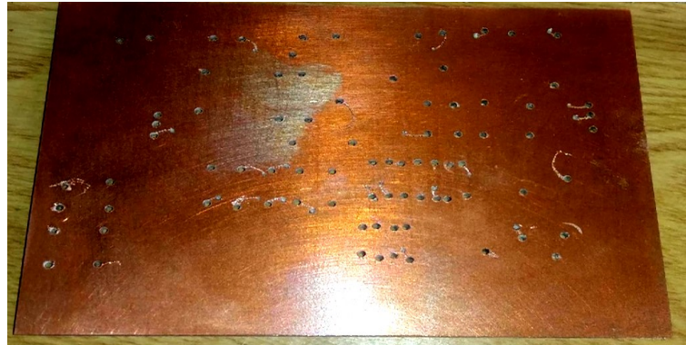
Fig.31: Baquelita con las perforaciones del Circuito de Carga
