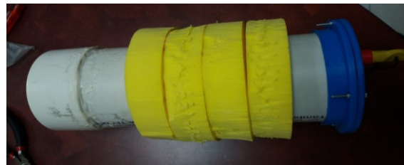
Fig.69: Colocación de la tapa superior en el recipiente hermético.
