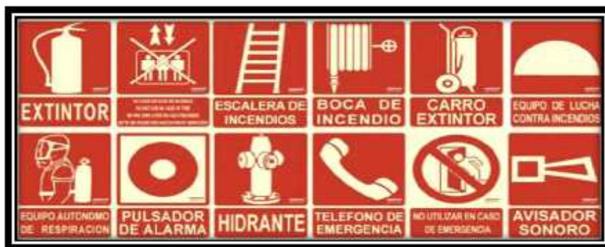
IMAGEN N° 41 SEÑALES DE EQUIPOS CONTRA INCENDIOS
