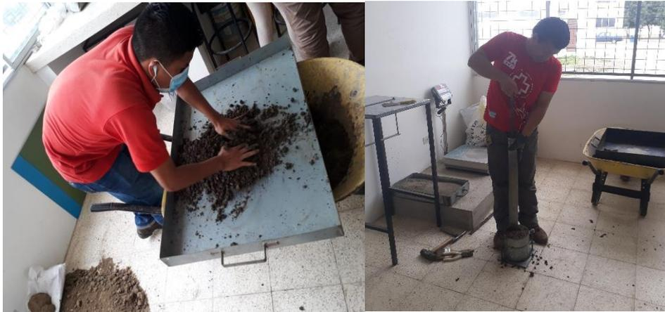
*Figura 51 Ensayo Proctor Modificado.*
