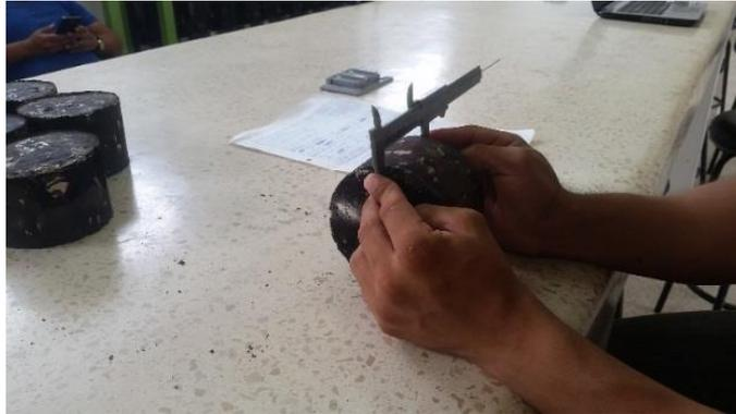
*Figura 63 Medición de las altura y diámetros de cada briqueta*
