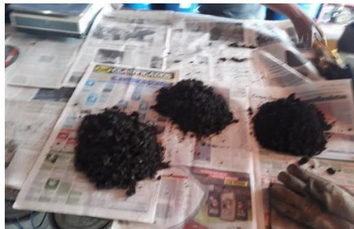
*Figura 59 Material listo para su colocación en el martillo Marshall para su compactación*
