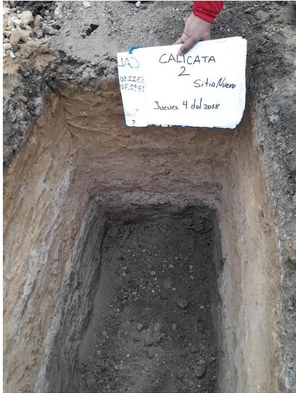
*Figura 37 Pozo a cielo abierto – calicata 2*
