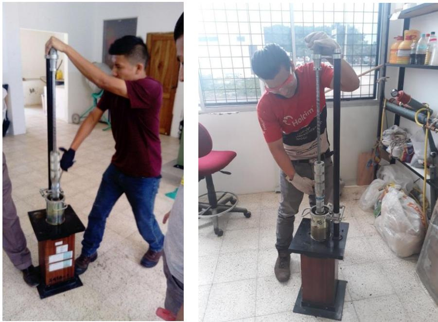
*Figura 60 Compactación de mezcla con emulsión asfáltica en el martillo Marshall*
