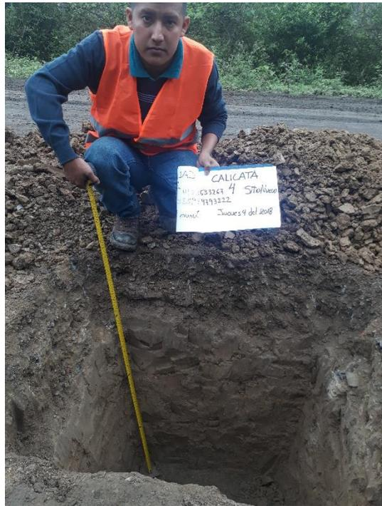
*Figura 39 Pozo a cielo abierto – calicata 4*
