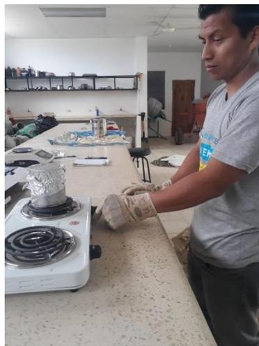
*Figura 57 Ensayo de residuo de evaporación en la emulsión asfáltica
