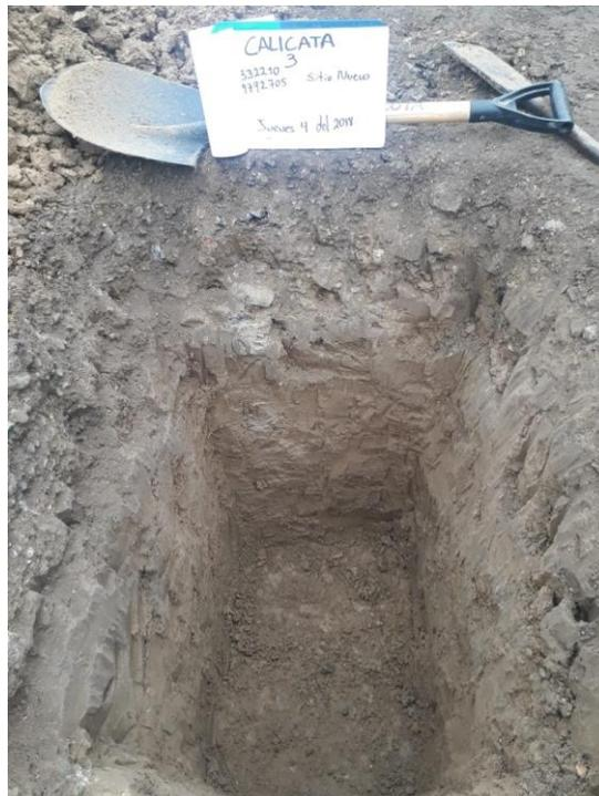
*Figura 38 Pozo a cielo abierto – calicata 3*
