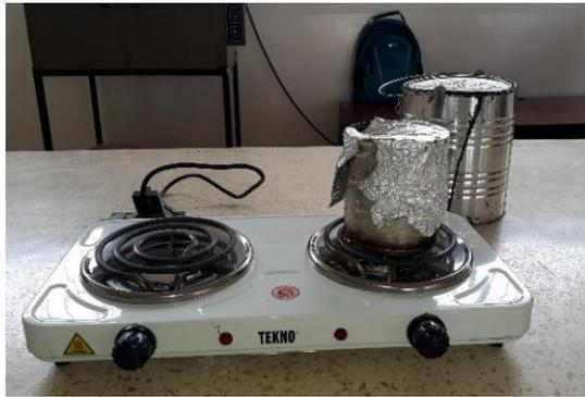
*Figura 56 Materiales usados para el ensayo de residuo de evaporación
