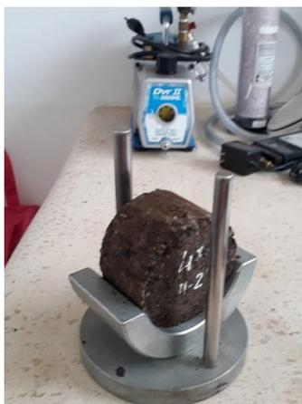
*Figura 68 Retiro de la briqueta después de la rotura máxima.*
