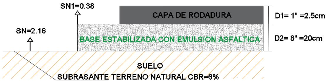
Figura 85 Espesores de capa de la estructura de pavimento con base estabilizada con emulsión asfáltica
