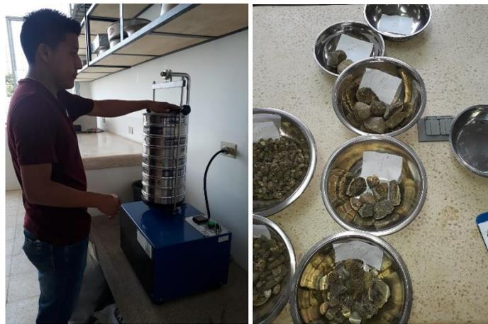
*Figura 44 Granulometría tamizadora (Vía seca) - Muestras Tamizadas.*
