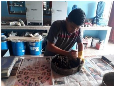
*Figura 58 Mezclado de los materiales (suelo, agua y emulsión), antes de su compactación.*
