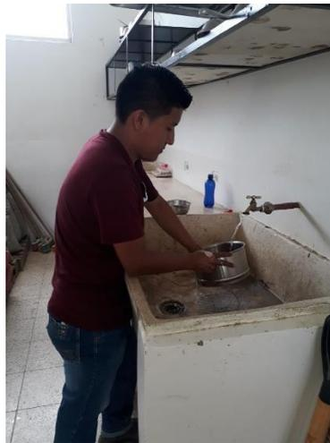
*Figura 43 Granulometría Método lavado (Vía húmeda).*
