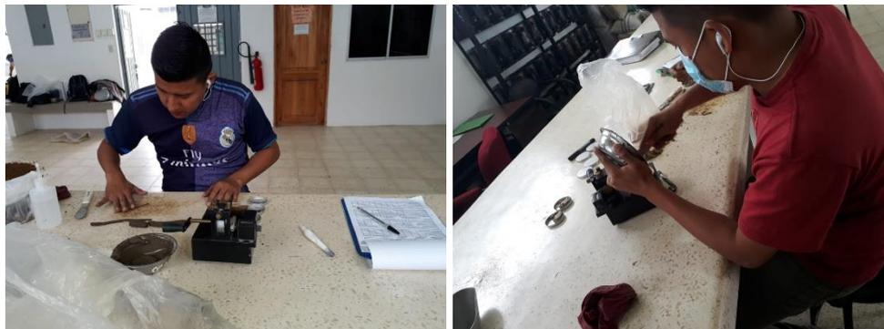
*Figura 45 Ensayo de límites de Atterberg.*
