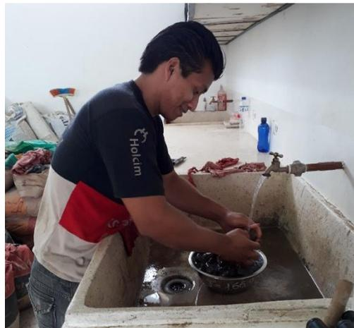
*Figura 48 Lavado del material previo al ensayo de abrasión de los Ángeles
