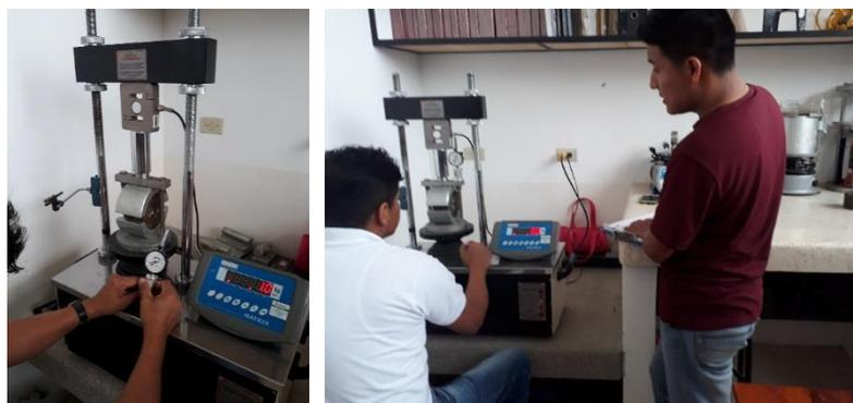
*Figura 67 Aplicación y medición de carga y flujo en las briquetas.*
