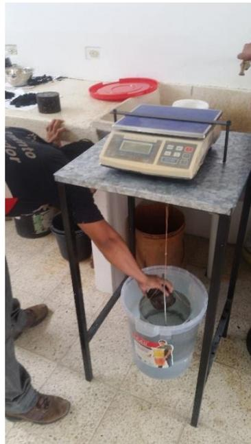
*Figura 66 Sumergido de briquetas en el agua con una canastilla*
