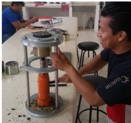
*Figura 61 Extracción de las briquetas por medio del gato extractor.*
