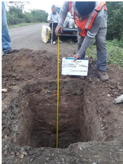
*Figura 40 Pozo a cielo abierto – calicata 5*
