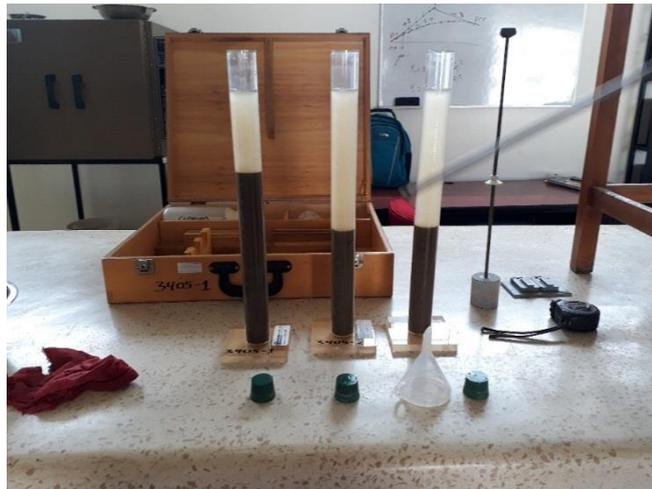
*Figura 47 Periodo de sedimentación del material en la solución de trabajo*
