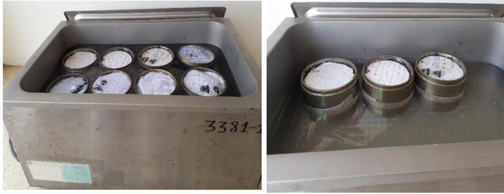
*Figura 65 Curado en agua (saturación).*
