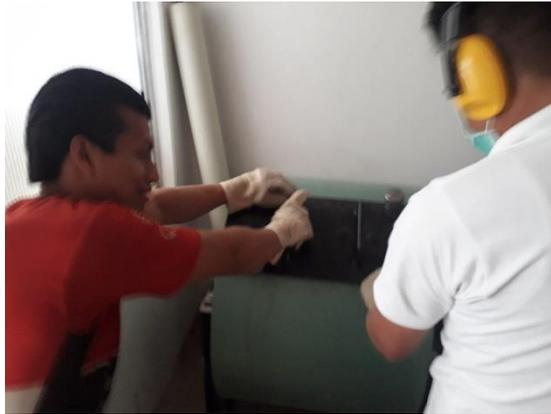
*Figura 49 Ajuste de la tapa de la máquina de abrasión*
