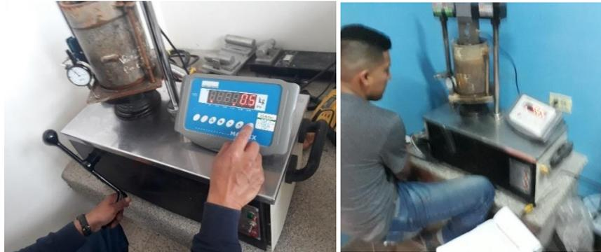
*Figura 53 Prensa hidráulica – Rotura de cilindros CBR.*
