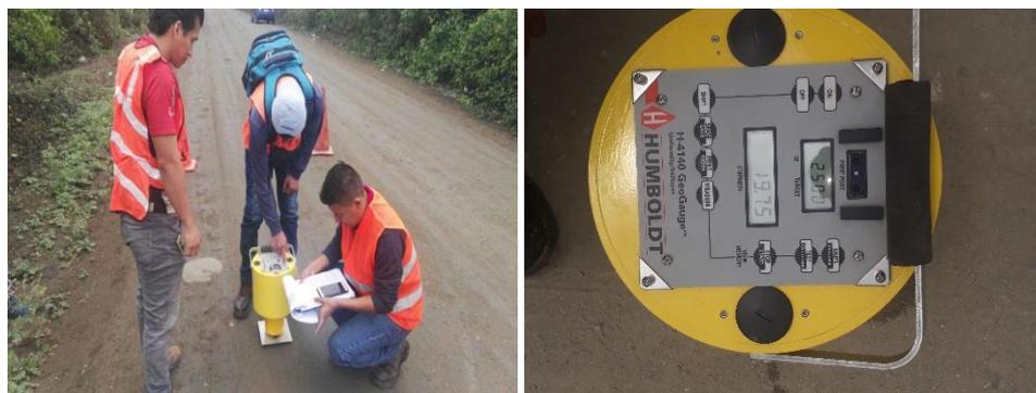
Figura 54 Toma de lectura con Geo-Gauge – Equipo Geo-Gauge
