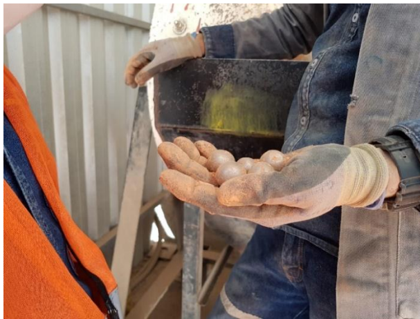
Figura 14 Cuerpos esféricos de acero que contiene el molino de bolas en su interior Fuente: M. Prudente, R. Vallejo
