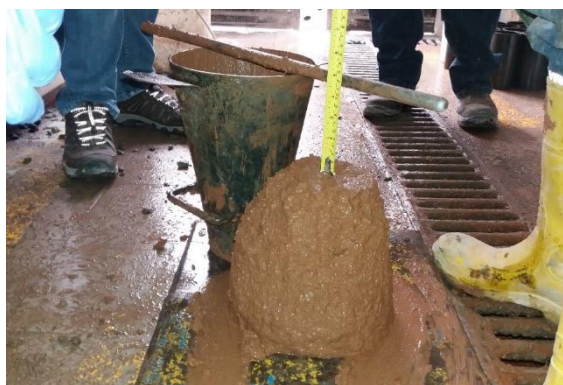
Figura 22 Medida del asentamiento de las mezclas de hormigón Fuente: M. Prudente, R. Vallejo
