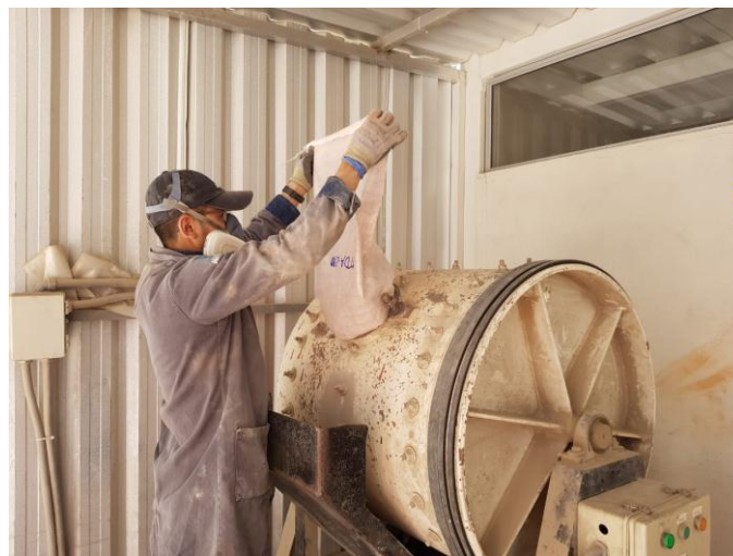
Figura 13 Vaciado del material para la molienda de LC3 Fuente: M. Prudente, R. Vallejo
