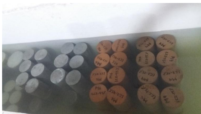
Figura 20 Curado de especímenes Fuente: M. Prudente, R. Vallejo
