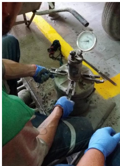
Figura 24 Ensayo de aire ocluido mediante método de presión Fuente: M. Prudente, R. Vallejo
