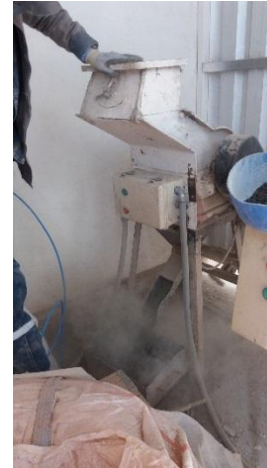
Figura 12 Trituración del Clinker para la molienda de LC3 Fuente: M. Prudente, R. Vallejo
