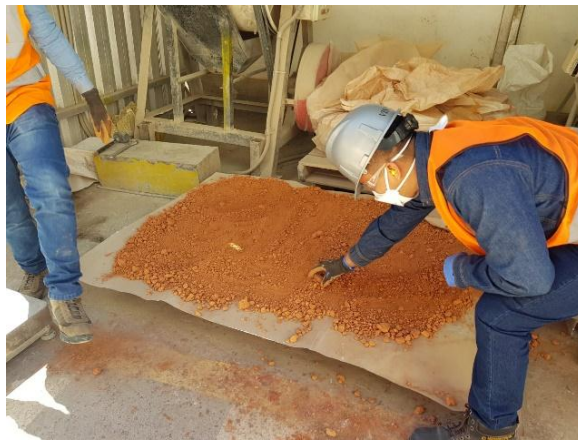
Figura 9 Limpieza de arcilla calcinada con el uso de imanes Fuente: M. Prudente, R. Vallejo
