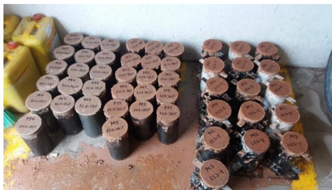
Figura 19 Probetas de hormigón con diferentes mezclas a ensayar Fuente: M. Prudente, R. Vallejo
