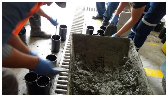
Figura 18 Elaboración de probetas de hormigón de 10x20 cm Fuente: M. Prudente, R. Vallejo
