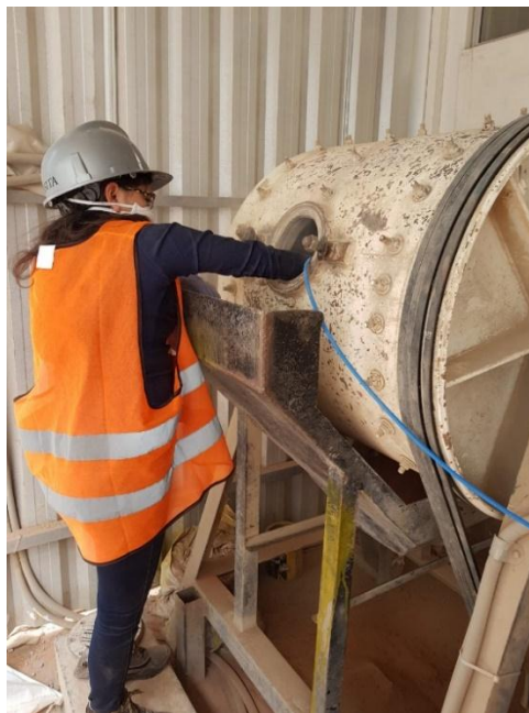
Figura 15 Limpieza del molido mediante aire a presión Fuente: M. Prudente, R. Vallejo
