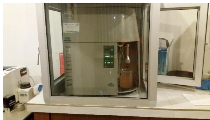
Figura 10 Determinación de la finura del material molido (Ensayo DTP) Fuente: M. Prudente, R. Vallejo
