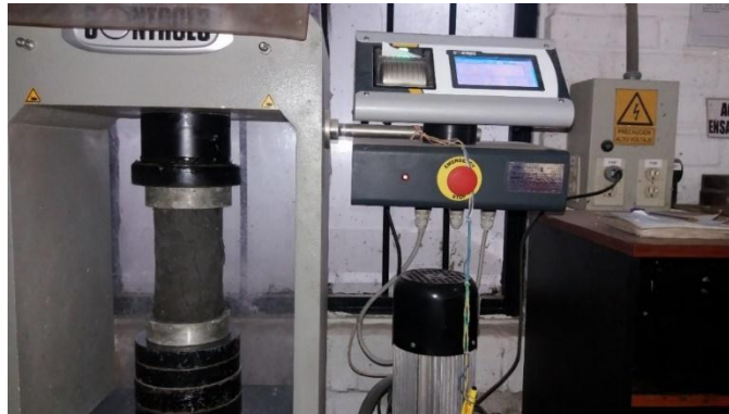
Figura 23 Ruptura de cilindros mediante el uso de la prensa Hidráulica Fuente: M. Prudente, R. Vallejo
