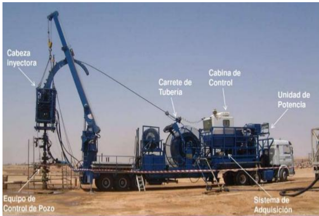
Figura 20 Inducción Con Tubería Flexible
