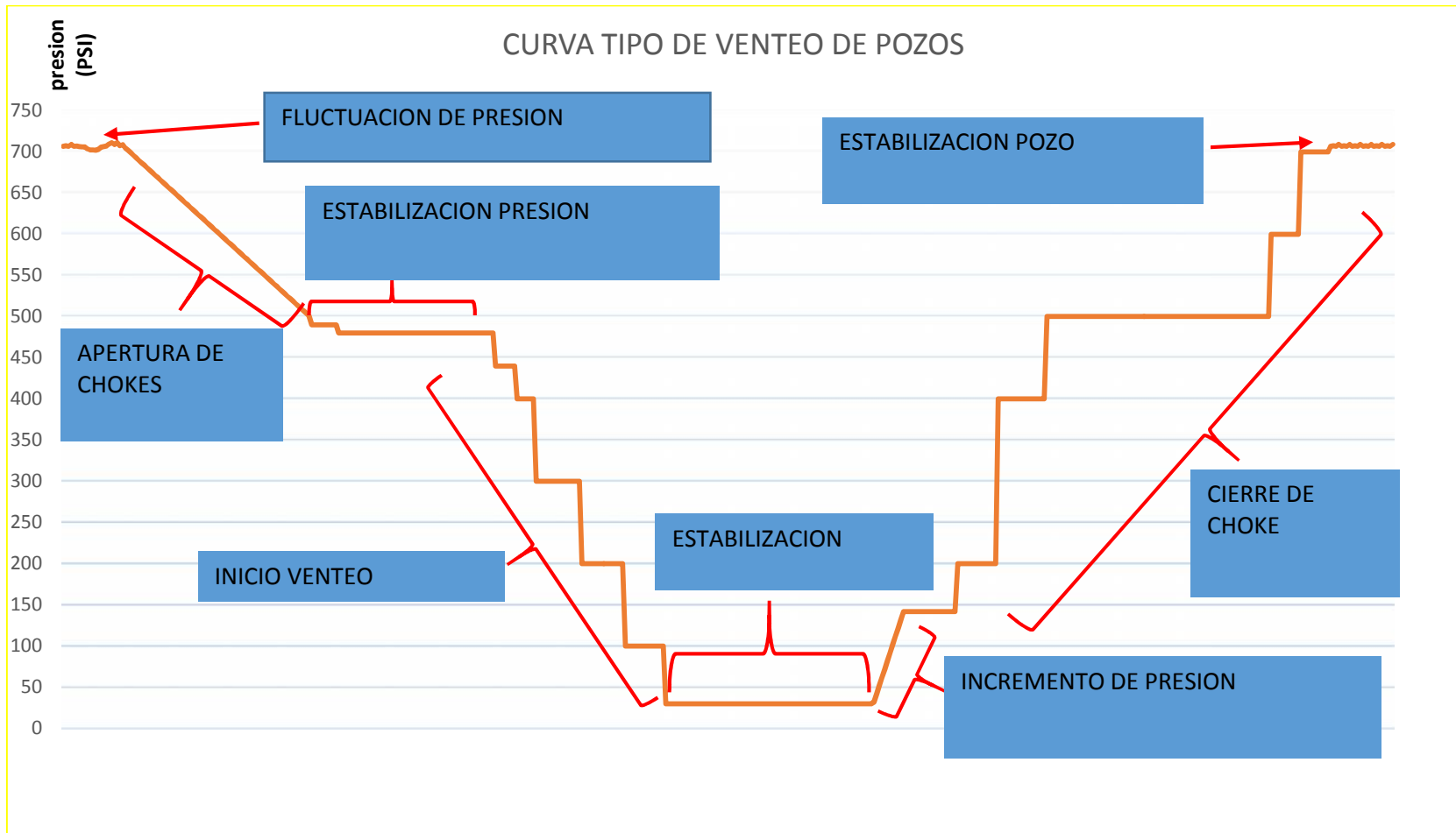
Figura 27 Curva Tipo De Proceso Blowing Down PSI
