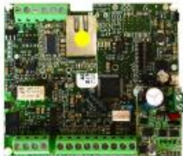
Ilustración 16. "Tarjeta de comunicación a CRA por línea telefónica y GRPS."
