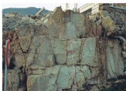
Granito. Calidad buena. Varias familias de discontinuidades alteradas.
