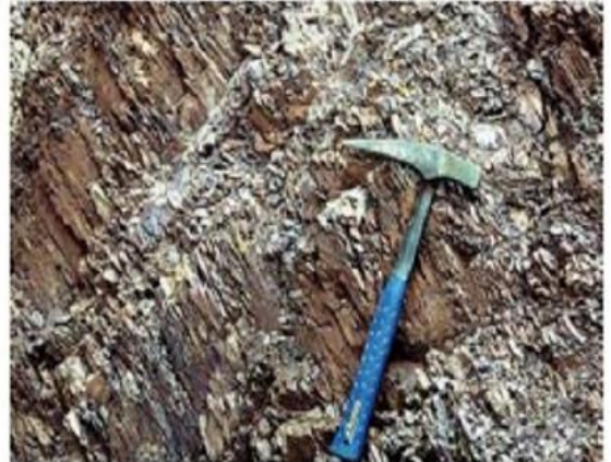
Pizarras paleozoicas. Calidad muy mala. Fracturación muy intensa. Grado de meteorización V.
