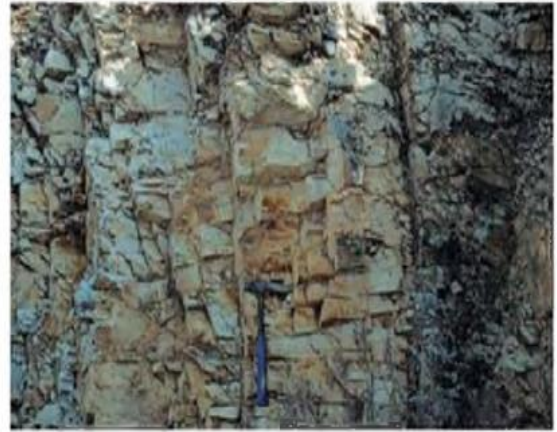
Cuarcitas ordovícicas. Calidad media. Grado de fracturación alto. Matriz rocosa muy resistente.
