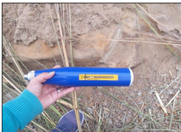
Figura 4.7.- Valor del número de rebotes obtenido in situ.
