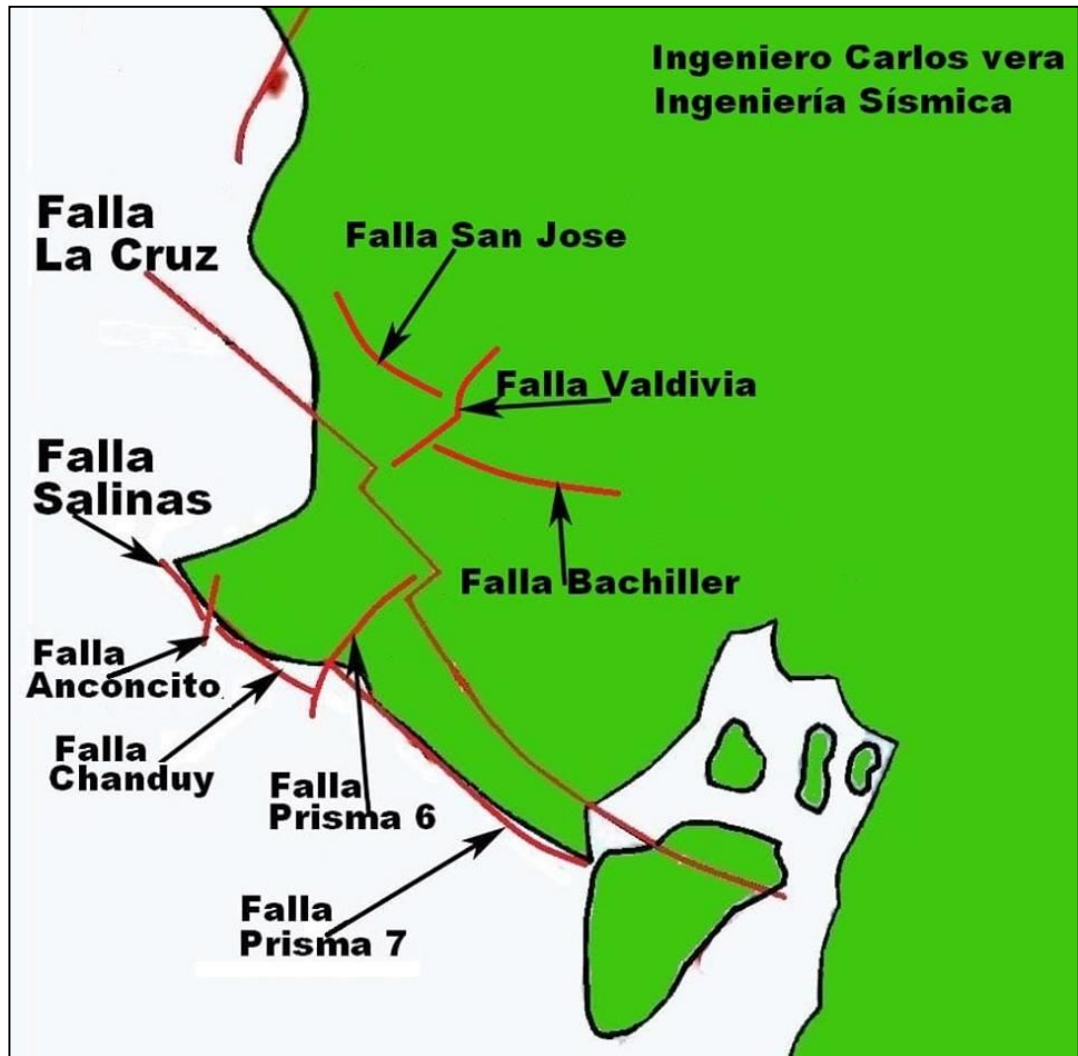
Figura 3.18.- Tipos de fallas locales.
