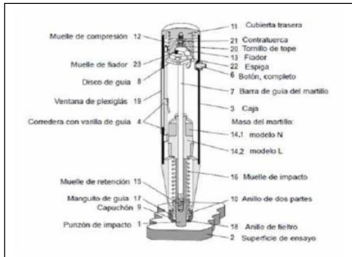
Figura 4.1.- Martillo de Schmidt y sus componentes (sección longitudinal).
