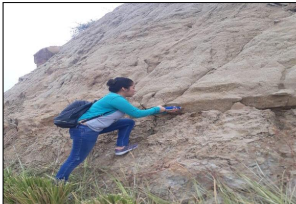
Figura 4.6.- Ensayo de rebote con el martillo de Schmidt.
