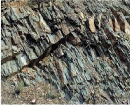
Pizarras ordovícicas. Calidad media. Grado de fracturación alto. Grado de meteorización: III.
