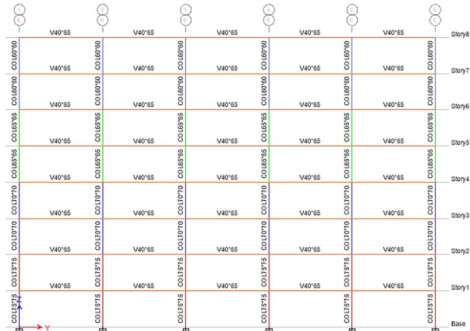
**Figura 28.** Elevación de pórtico del eje "C" con secciones predimensionadas
