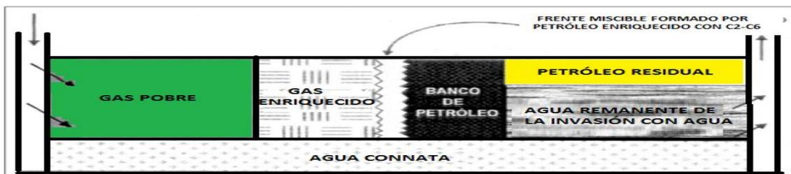
Figura 9. Proceso de Inyección de Gas Condensante.
