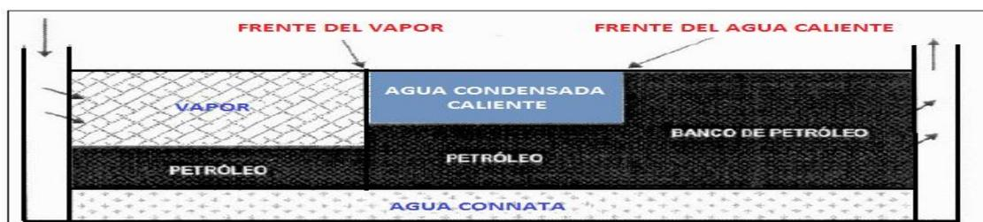
Figura 13 Proceso de Inyección continua de vapor.
