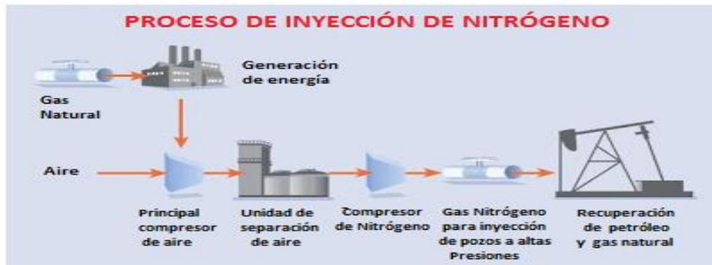
Figura 7. Proceso de Inyección de Nitrógeno (N<sub>2</sub>).
