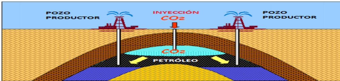
Figura 6. Inyección de dióxido de Carbono (CO<sub>2</sub>).
