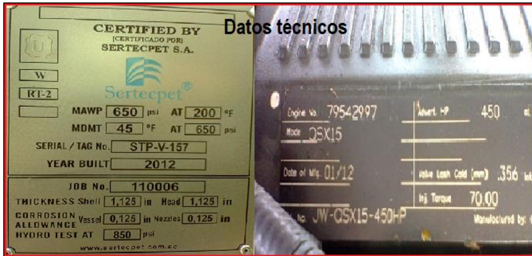
Ilustración 15: Datos técnicos del motor y separados en una MTU
