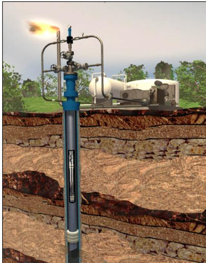
Ilustración 6: Esquema de un bombeo Hidráulico y sus componentes en superficie y subsuelo
