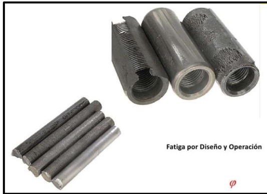
Figura 36: Fallas por fatiga de diseño y operación. Fuente: KEDE Consulting S.A.
