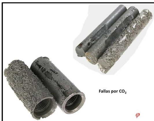
Figura 38: Fallas por CO 2 . Fuente: KEDE Consulting S.A.
