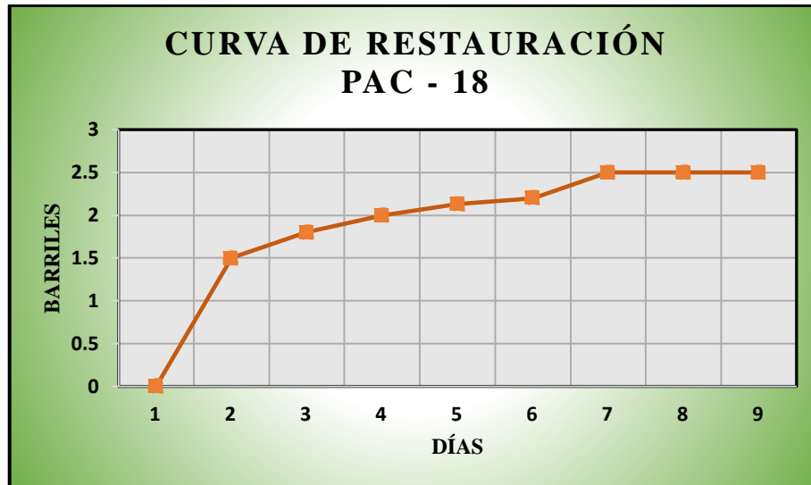
Figura 58: Curva de restauración de nivel del pozo seleccionado.
