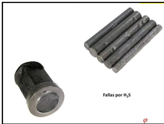
Figura 37: Fallas por H 2 S. Fuente: KEDE Consulting S.A.
