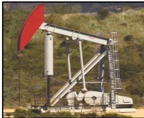
Figura 22: Unidad de bombeo balanceada por aire. Fuente: Engineering & Technology S.A.C.
