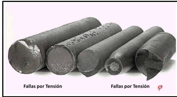
Figura 39: Fallas por tensión. Fuente: KEDE Consulting S.A.
