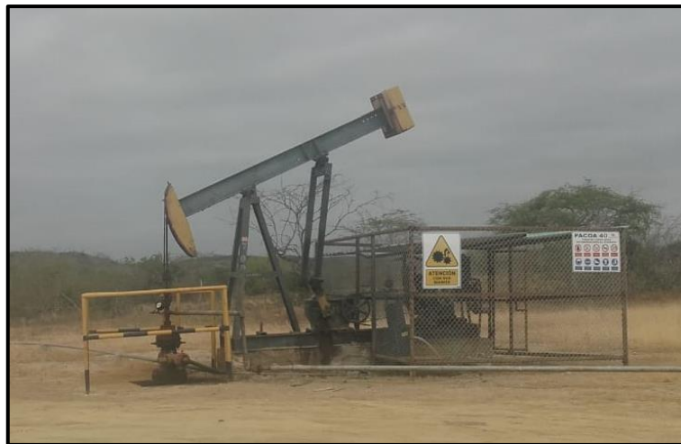
Figura 18: Unidad de bombeo mecánico - pozo PAC 040.
