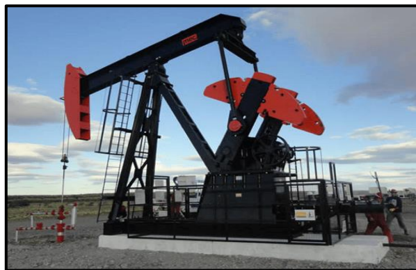
Figura 20: Unidad de bombeo convencional.
