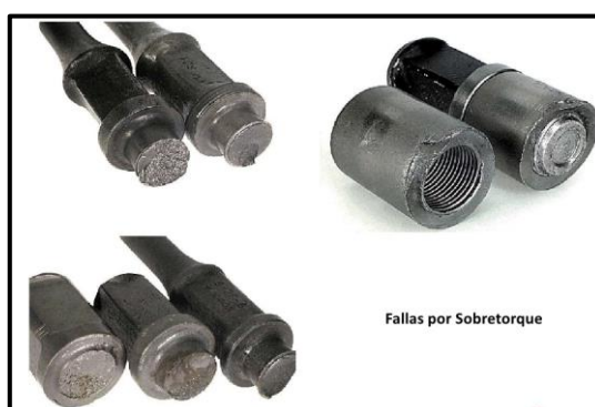
Figura 35: Fallas por sobretorque.
