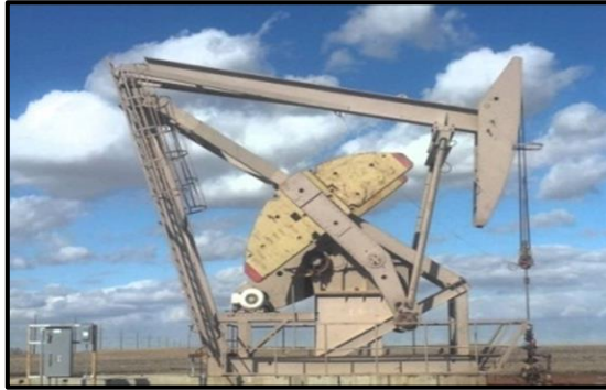
Figura 21: Unidad de bombeo Mark II. Fuente: Engineering & Technology S.A.C.
