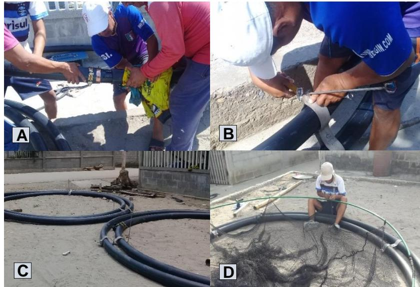
**Foto 8.** Construcción de las estructuras de cultivo. A) Unión del tubo de polietileno 3" para la formación de la circunferencia, B) Ajuste de abrazaderas metálicas, C) Aros de flotación, D) Montaje del recinto contenedor (red anchovetera).
