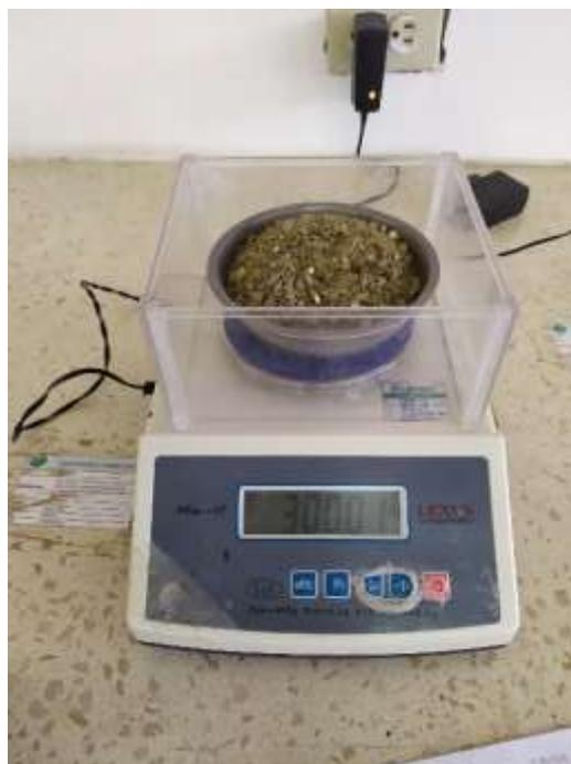
*Figura 17. Material para granulometría vía húmeda*
