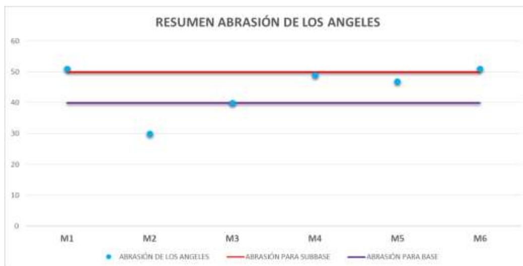
Figura 27. Resumen del ensayo de Abrasión de los Ángeles.
