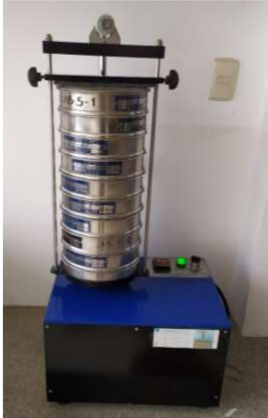
*Figura 16. Maquina tamizadora para realizar la clasificación del suelo*
