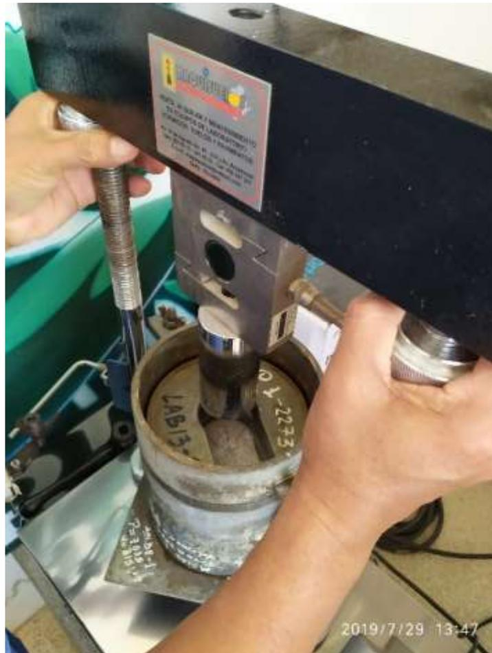
*Figura 22. Preparación de la muestra para la penetración*
