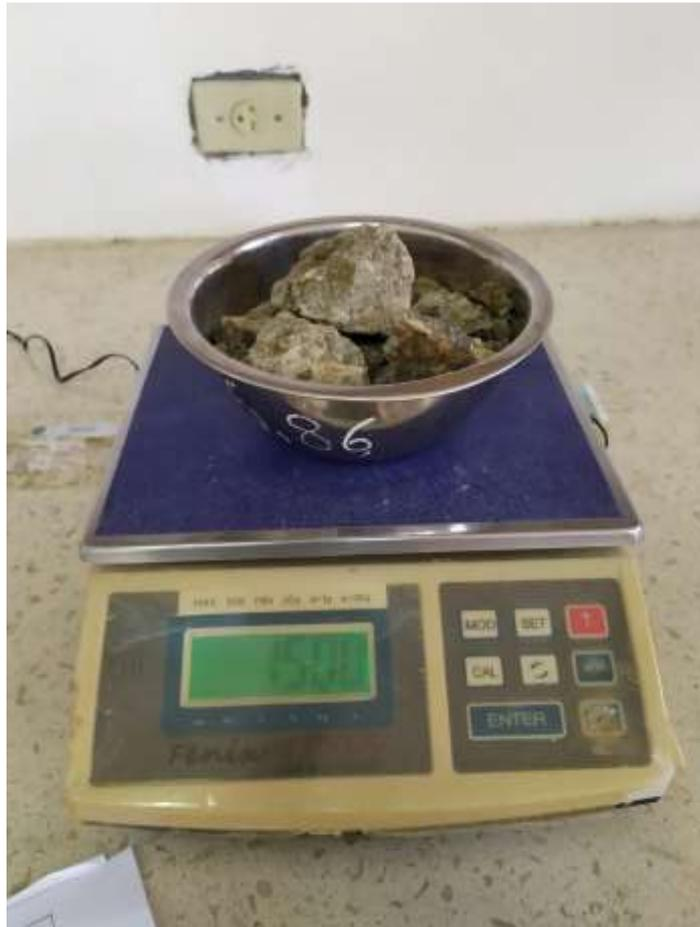
*Figura 15. Material para obtener contenido de humedad*
