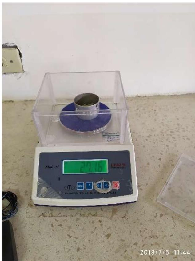
*Figura 18. Muestra secada en el horno del límite plástico*
