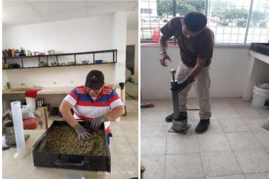
*Figura 20. Ensayo de Proctor Modificado*
