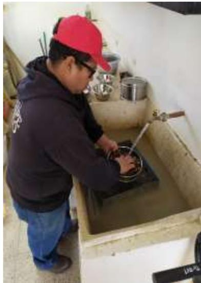
*Figura 19. Lavado de material para ensayo de Abrasión*
