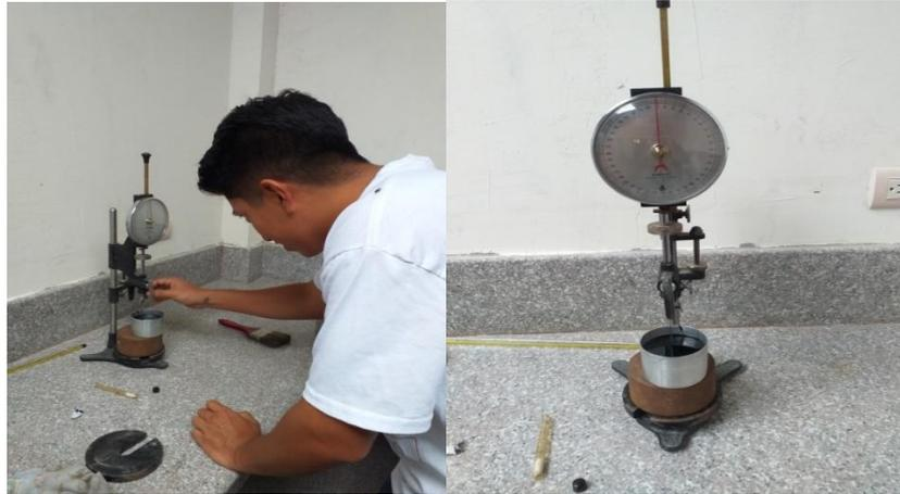
*Figura 5. Ensayo de Penetración.*
