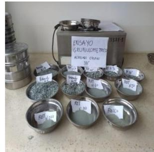
*Fracciones Retenidas de los Agregados en cada Tamiz.*
