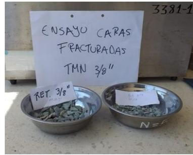
*Fracciones de los Agregados para el Ensayo.*
