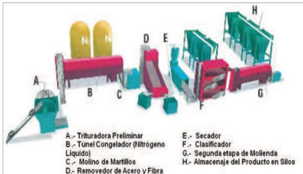
*Figura 12. Esquema de Planta de trituración Criogénica de Neumáticos.*
