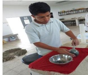
*Llenado del Picnómetro con el Agregado y extracción de las burbujas de aire.*
