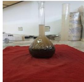
*Picnómetro con el Agregado SSS más el Agua (cisco y arena).*
