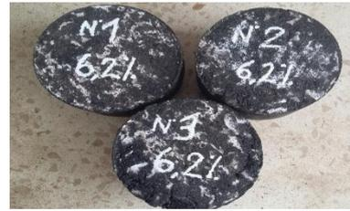
*Briquetas con el porcentaje óptimo de asfalto.*
