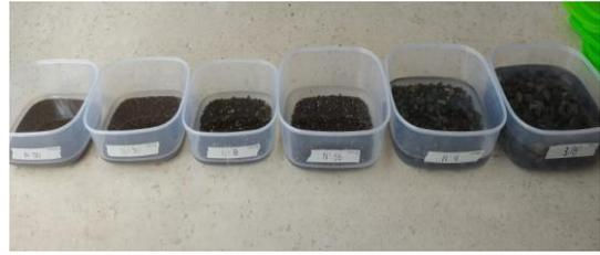
*Adición del Sulfato de Magnesio en el Agregado.*
