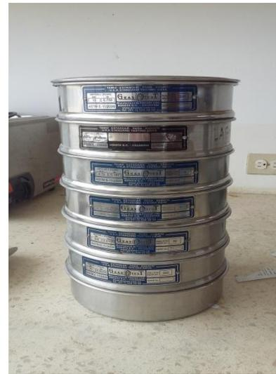
*Tamices a utilizar en el ensayo.*
