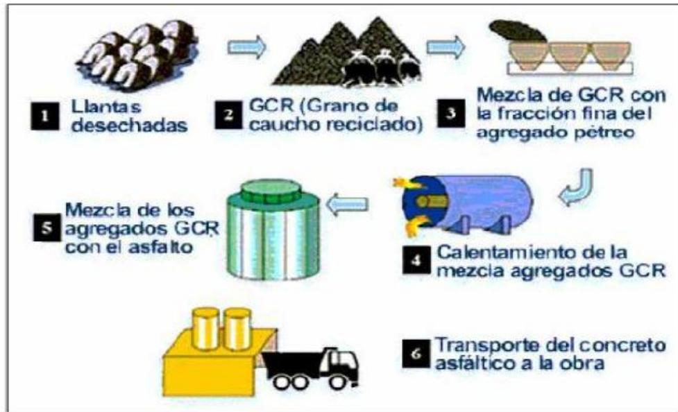
*Figura 10. Esquema de Fabricación de la Mezcla Asfáltica con Caucho por Vía Seca.*
