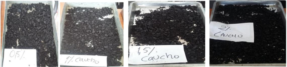
*Mezcla Asfáltica con porcentajes de caucho para el ensayo.*
