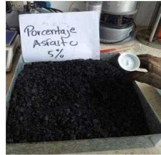
*Adición de asfalto y mezclado con los porcentajes de asfalto.*
