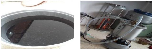
*Muestra y extracción de vacíos de aire.*
