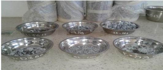
*Material con Sulfato Secado al Horno.*
