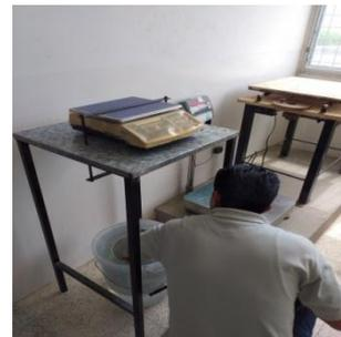
*Determinación del peso seco, SSS y sumergido de las briquetas.*
