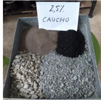
*Distribución del Caucho Triturado a los agregados para el mezclado.*
