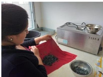
*Secado del Agregado Saturado Superficialmente Seco (SSS).*
