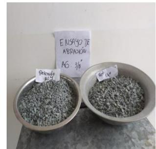
*Fracciones de Agregados 3/4" y 3/8" a Utilizar.*
