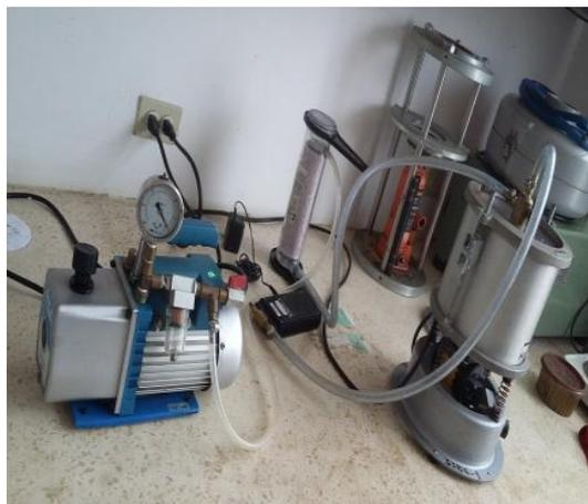
*Equipos para el ensayo Rice.*
