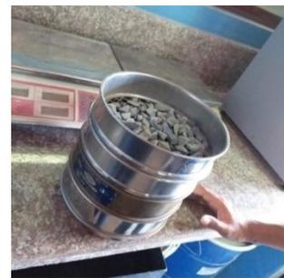
*Selección de las Fracciones de Agregados 3/4" y 3/8" a Utilizar.*
