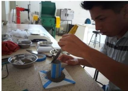
*Nivelación del agregado en el cilindro.*
