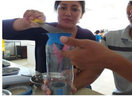
*Colocación y nivelación del agregado en el embudo.*
