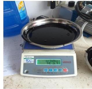
*Determinación de las Temperaturas del Asfalto, los Agregados y posterior pesos para la mezcla.*
