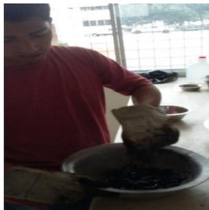
*Mezclado del agregado con el asfalto.*
