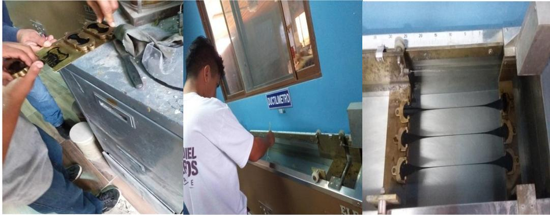
**Figura 7. Ductilidad de una mezcla asfáltica.**
