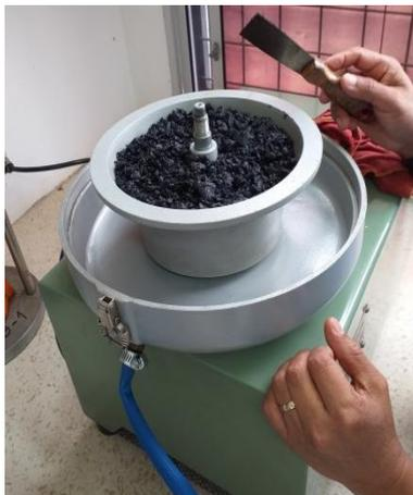
*Muestra y solución colocada en la taza de extracción.*
