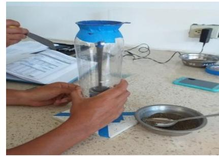
*Caída del agregado en el cilindro.*
