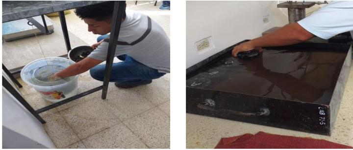
*Peso en el aire, SSS y sumergido de las briquetas con caucho.*
