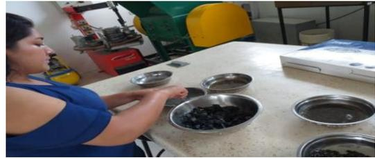
*Lavado de los Agregados con Cloruro de Bario para la Extracción del Sulfato.*
