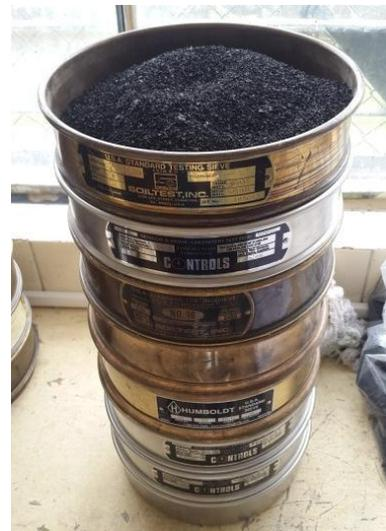
*Tamices a utilizar en el ensayo.*
