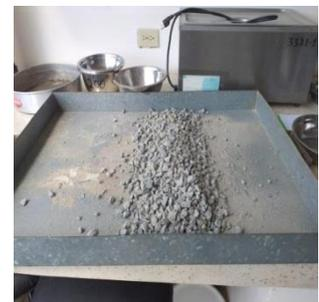
*Proceso de Desgaste de los Agregados en la Máquina de los Ángeles.*
