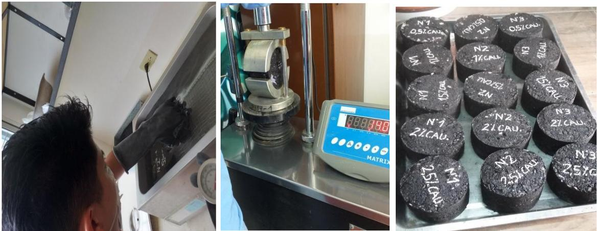
*Rotura de Briquetas con caucho.*
