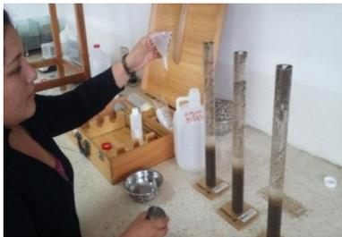
*Colocación del material en los cilindros*
