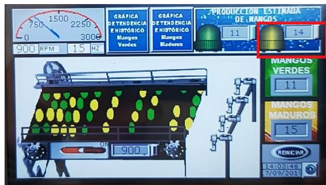
Figura 133. Prueba de alarma desactivada después de alcanzar la producción estimada de mangos maduros mediante interfaz HMI.
