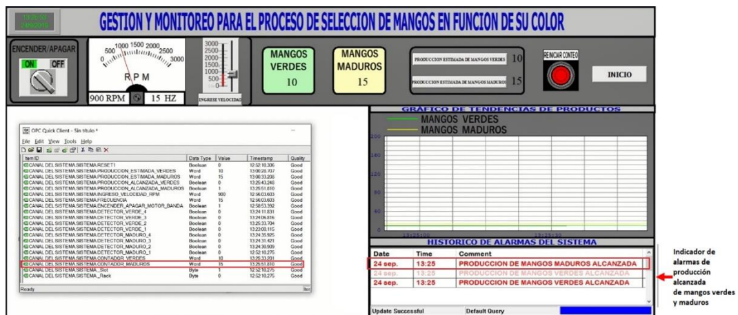
Figura 130. Prueba de alarma activada al alcanzar la producción estimada de mangos maduros mediante SCADA.
