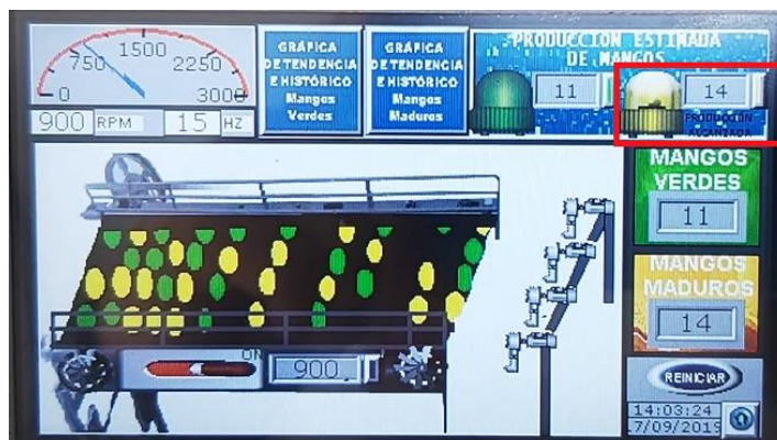
Figura 131. Prueba de alarma activada al alcanzar la producción estimada de mangos maduros mediante interfaz HMI.
