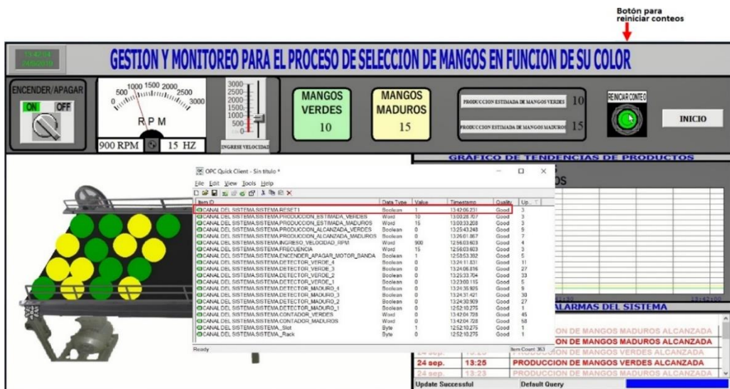
Figura 134. Prueba del botón para reiniciar el conteo de mangos verdes y maduros mediante SCADA y activación de su variable en KEPServer.
