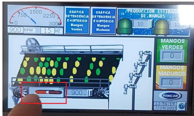
Figura 117. Prueba de encendido del motor para la banda transportadora del sistema mediante interfaz HMI.
