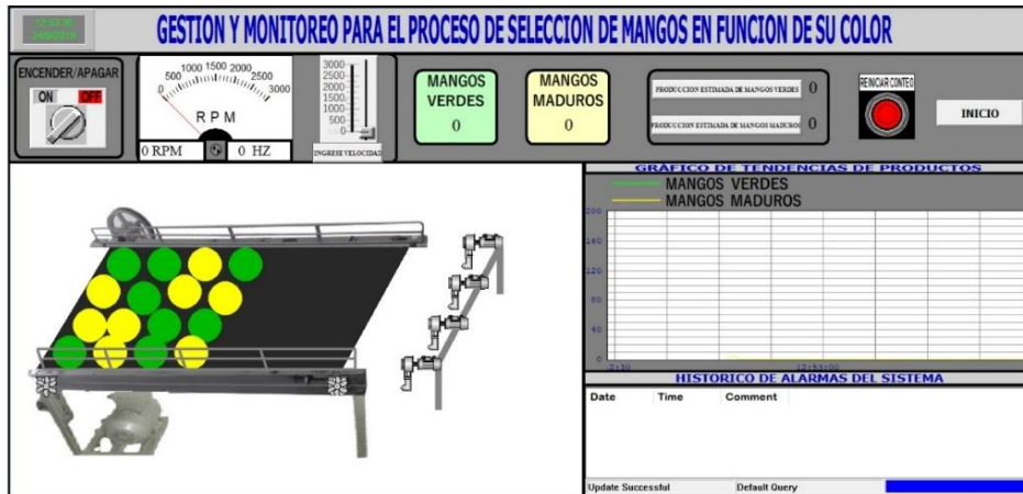
Figura 110. Sistema SCADA totalmente apagado.
