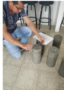
**Medición de probetas**
