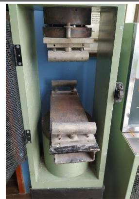
**Acople para rotura de vigas**
