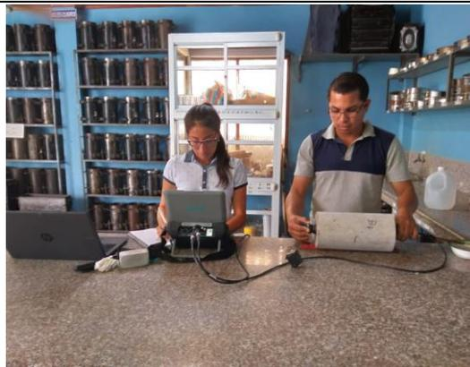
**Determinación de velocidad de onda**
