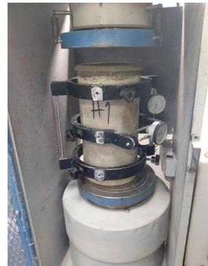
**Preparacion de muestra para ensayo de modulo elastico**
