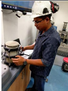
**Preparacion de muestra para ensayo de modulo elastico**
