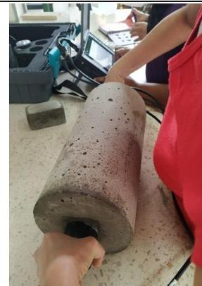
**Determinación de velocidad de onda**
