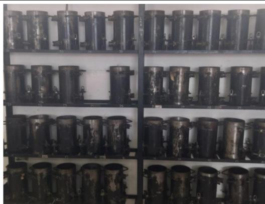
**Moldes para cilindros de hormigón**
