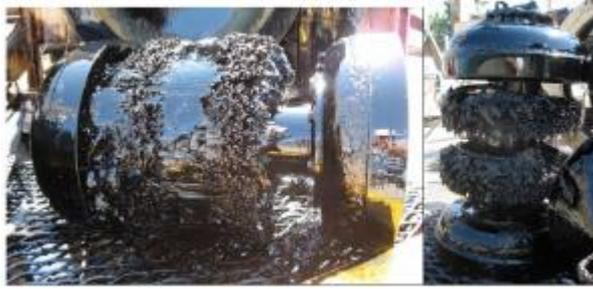
**Figura 6. Estado de los cepillos del rascador después de una limpieza de oleoducto.**
