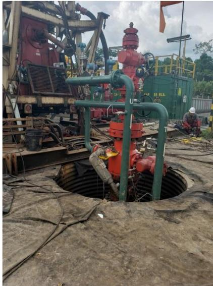
Figura 4.26: Cabezal de pozo de una completación Dual.
