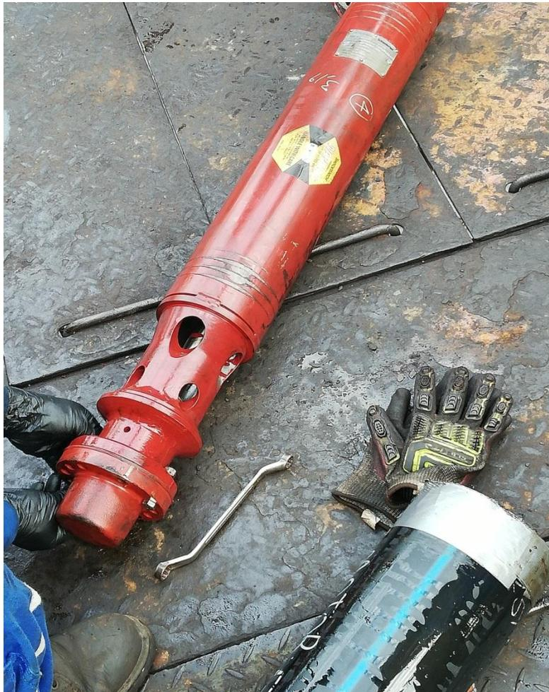
Figura 4.14: Intake o Separador de gas.
