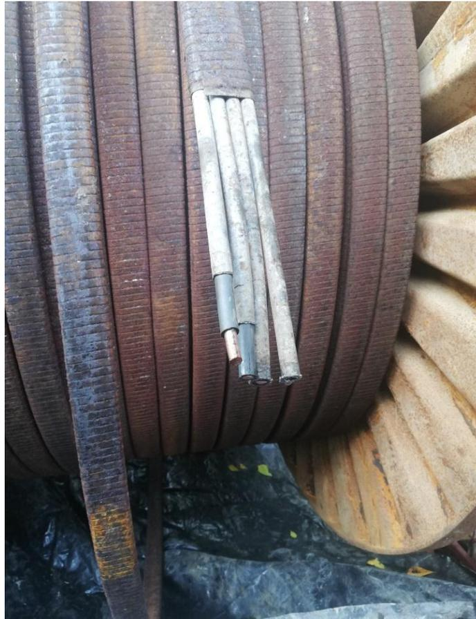
Figura 4.13: Carreto con cables de potencia y capilar.
