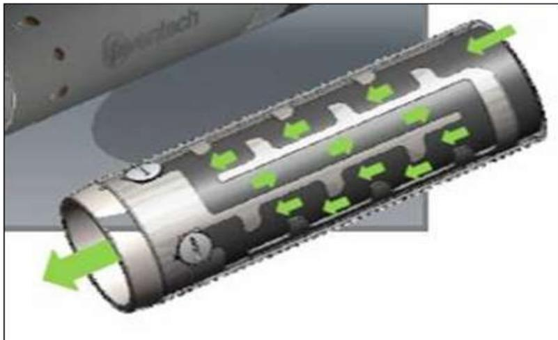
FIGURA # 9.- ICD Tipo Laberinto.
