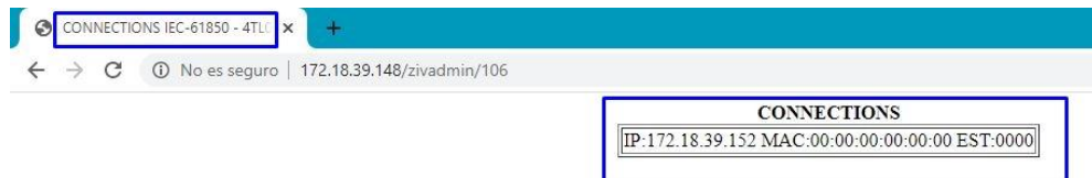
Figura 116: Comunicación entre el IED ZIV 8IDV con la RTU del módulo de pruebas mediante IEC 61850.
