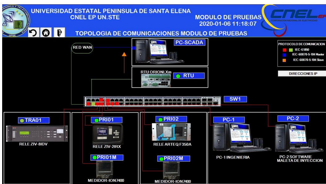
Figura 95: Pantalla monitoreo de comunicación entre los IEDs módulo de pruebas.
