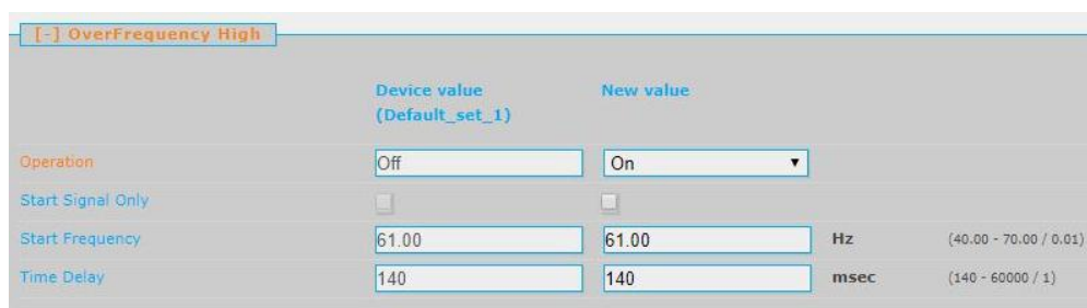
Figura 141: Ajuste función de sobrefrecuencia IED Arcteq AQF350A.
