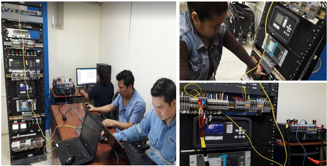
Anexo 9: Implementación módulo de pruebas con el SCADA Local en el COD-STE.
