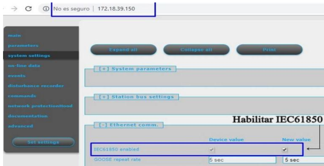
Figura 54: Activación IEC 61850 en el IED AQF350A desde el servidor web.
