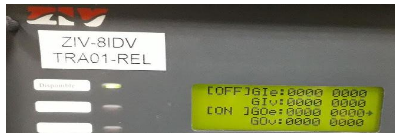
Figura 153: Verificación envío de mensaje Goose desde el IED publicador.
