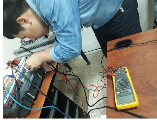
Anexo 12: Medición de voltaje DC a la salida de la maleta de inyección.
