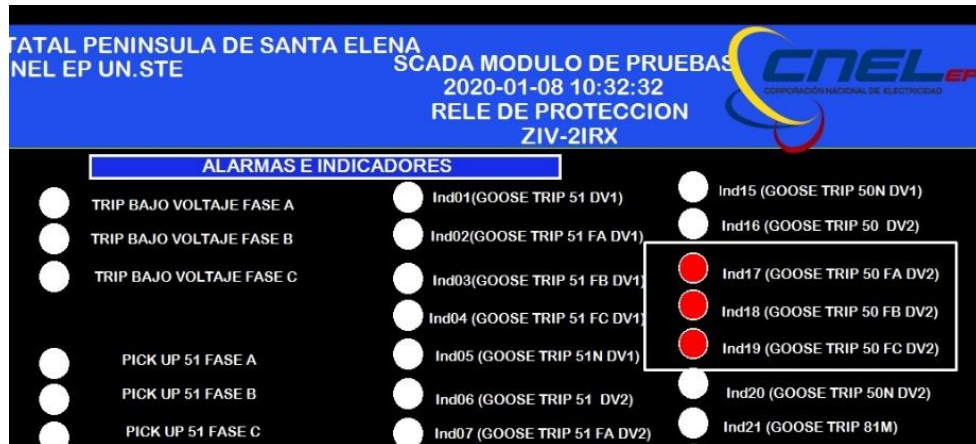
Figura 158: Visualización en el SCADA indicadores de recepción mensajes Goose.
