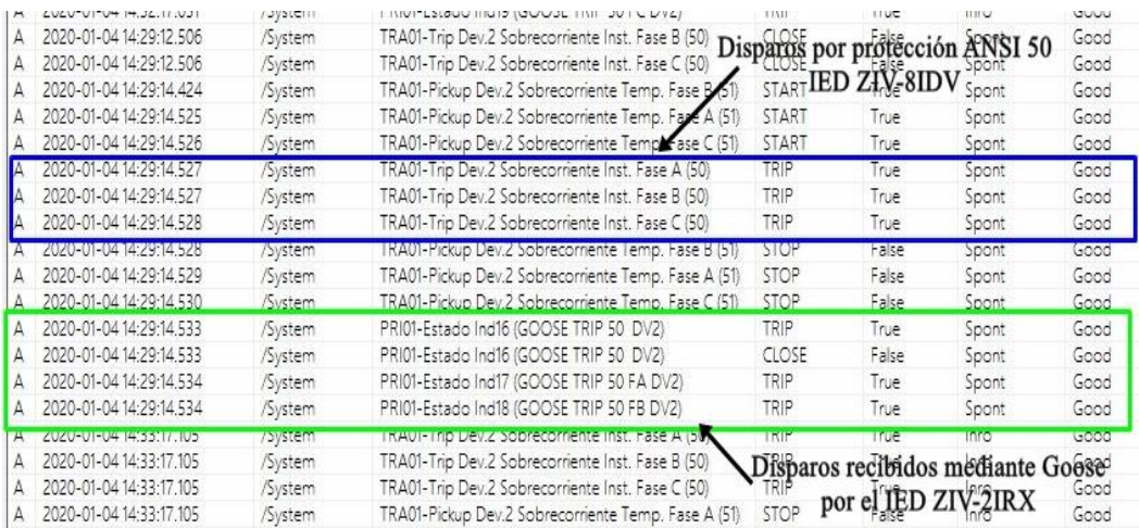
Figura 157: Disparos y mensajes Goose en el visualizador de eventos del SCADA.
