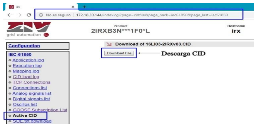
Figura 44: Descarga del archivo CID servidor web del IED ZIV2IRX.
