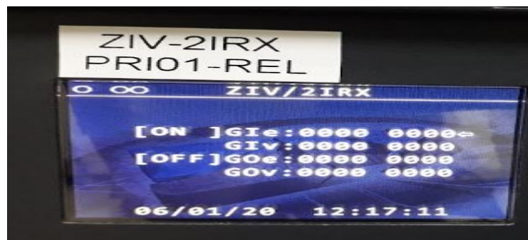
Figura 154: Verificación recepción de Goose IED suscriptor.
