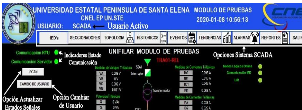
Figura 92: Indicadores y opciones pantalla principal SCADA.
