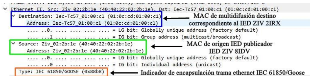
Figura 161: Capa de enlace de datos de una trama Goose.
