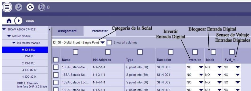
Figura 73: Asignación de entradas digitales al módulo DI-8112.
