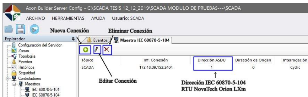
Figura 103: Canal Configurado mediante IEC 60870-5-104.
