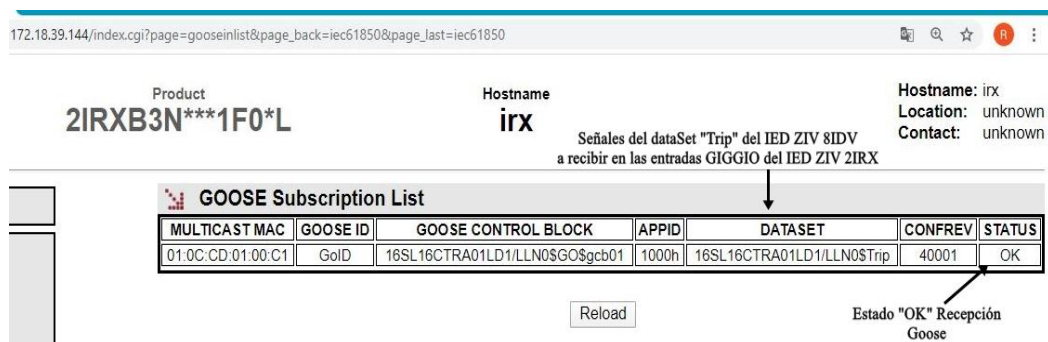
Figura 155: Verificación de recepción de Goose mediante el servidor web del IED suscriptor.
