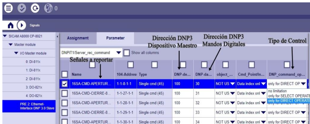
Figura 81: Configuración mandos digitales mediante DNP3 Slave.
