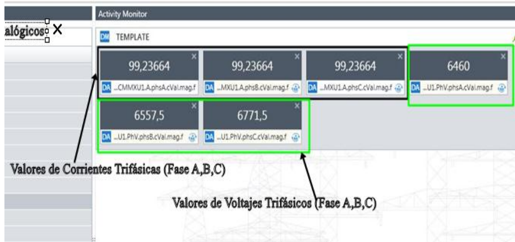
Figura 167: Lectura de valores de corrientes y tensiones desde los nodos lógicos CMMXU1 y VMMXU1 del IED AQF350A.
