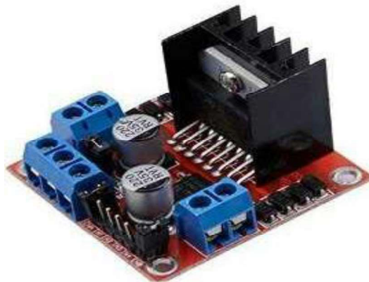
Ilustración 42 L298N controlador de motores DC
