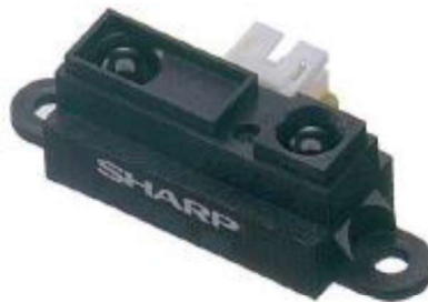
Ilustración 36 Sensor SHARP 2Y02A1 (10-80cm) [15]
