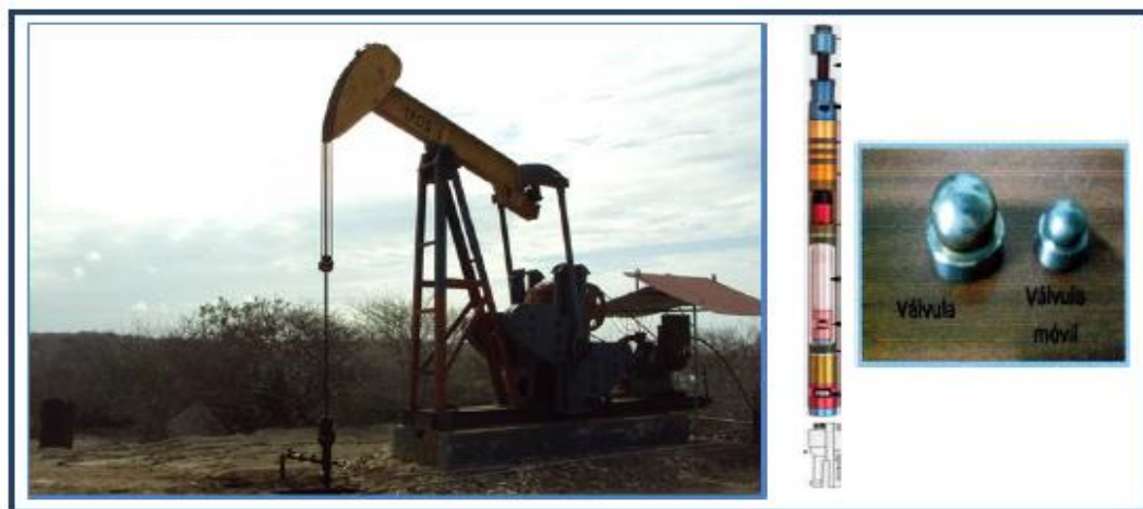
Ilustración 2.5 Sistema de levantamiento artificial por Bombeo Mecánico. Fuente: Pacifpetrol.
