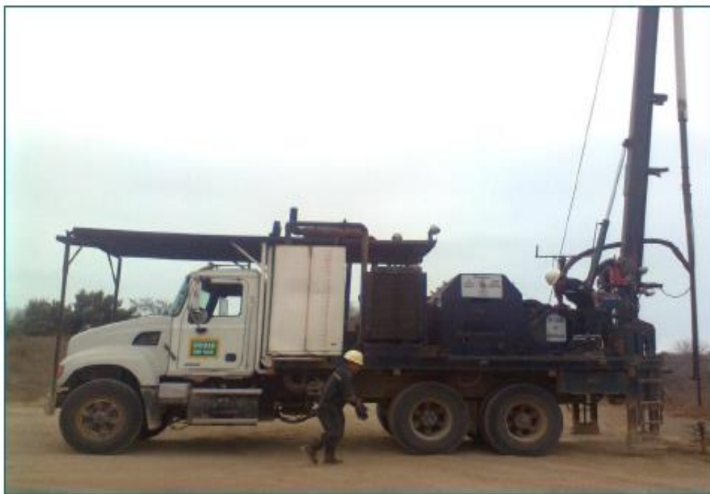
Ilustración 2.4 Sistema de levantamiento artificial por Swab o Pistoneo. Fuente: Pacifpetrol.
