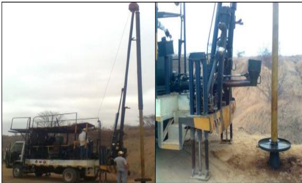
Ilustración 2.3 Sistema de levantamiento artificial por herramienta local. Fuente: Pacifpetrol.
