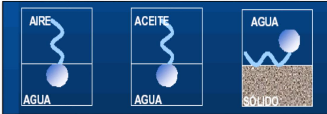
Figura 47. Adsorción del Surfactante en diferentes interfases (Velásquez, 2006)
