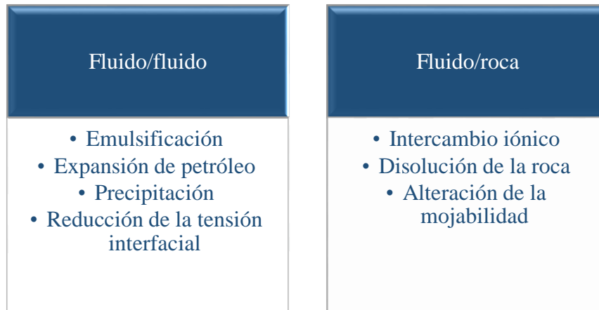
Diagrama 8. Interacciones presentes en la Inyección de Álcalis (B, 2013)
