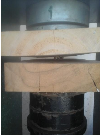
Figura 11: Ensayo modo de falla por tracción. Fuente: Laboratorio Ingeotop 2020 Elaborado por: Daniel del Pezo
