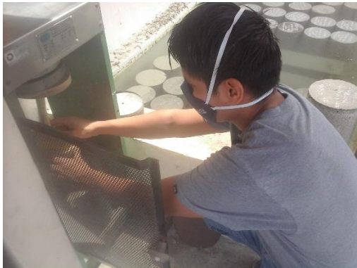
Figura 8: ensayo de compresión axial por pandeo Fuente: Laboratorio Ingeotop 2020 Elaborado por: Daniel del Pezo
