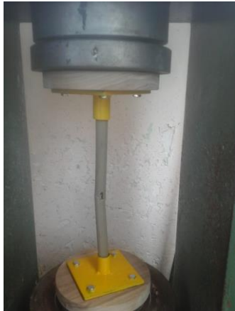
Figura 13: Ensayo pandeo flexionante tipo 1 muestras PLF1 a PLF3 Fuente: Laboratorio Ingeotop 2020 Elaborado por: Daniel del Pezo
