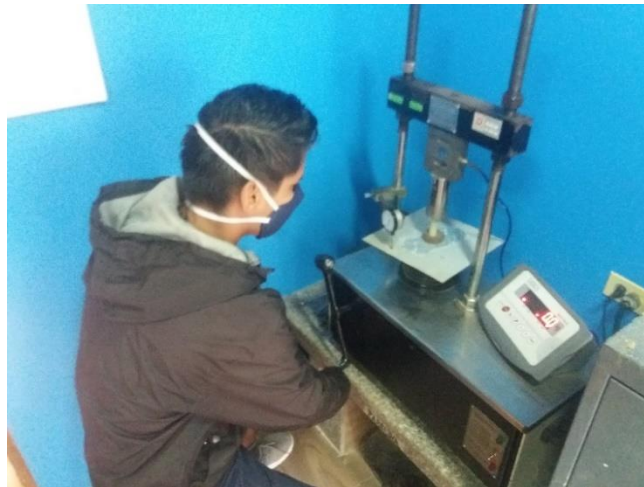
Figura 12: Ensayo para determinar Modulo de elasticidad Fuente: Laboratorio Ingeotop 2020 Elaborado por: Daniel del Pezo
