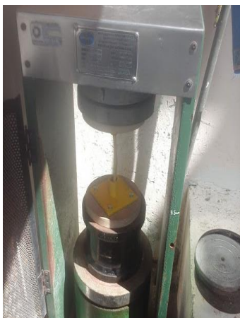
Figura 15: Ensayo pandeo flexionante tipo 3 muestras PLF6 a PLF8 Fuente: Laboratorio Ingeotop 2020 Elaborado por: Daniel del Pezo
