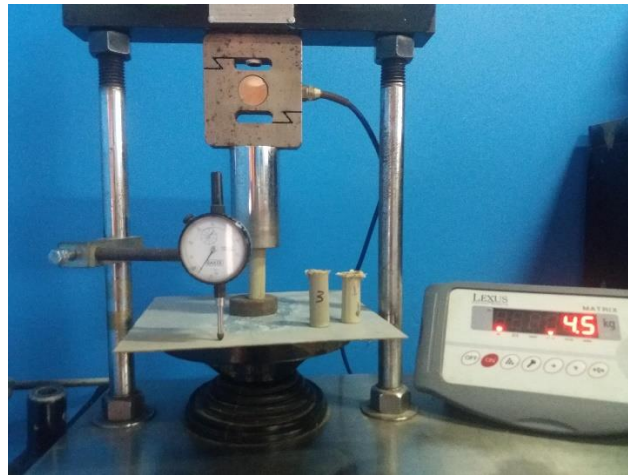
Figura 17: Ensayo para determinar módulo de elasticidad Fuente: Laboratorio Ingeotop 2020 Elaborado por: Daniel del Pezo
