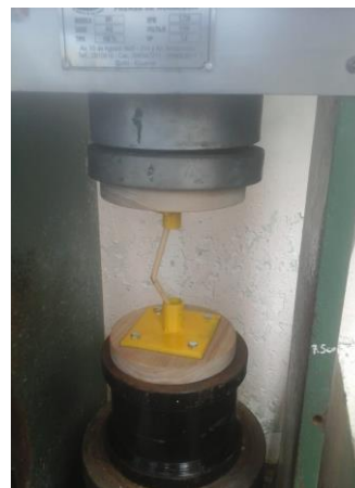
Figura 16: Ensayo pandeo flexionante tipo 4 muestras PLF9 a PLF11 Fuente: Laboratorio Ingeotop 2020 Elaborado por: Daniel del Pezo
