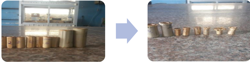
Figura 10: ensayo de compresión simple. Fuente: Laboratorio Ingeotop 2020 Elaborado por: Daniel del Pezo
