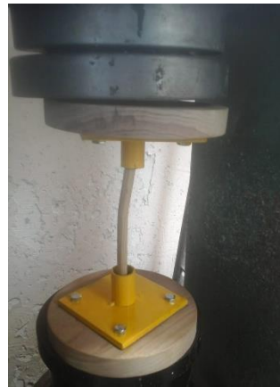
Figura 14: Ensayo pandeo flexionante tipo 2 muestras PLF4 a PLF5 Fuente: Laboratorio Ingeotop 2020 Elaborado por: Daniel del Pezo
