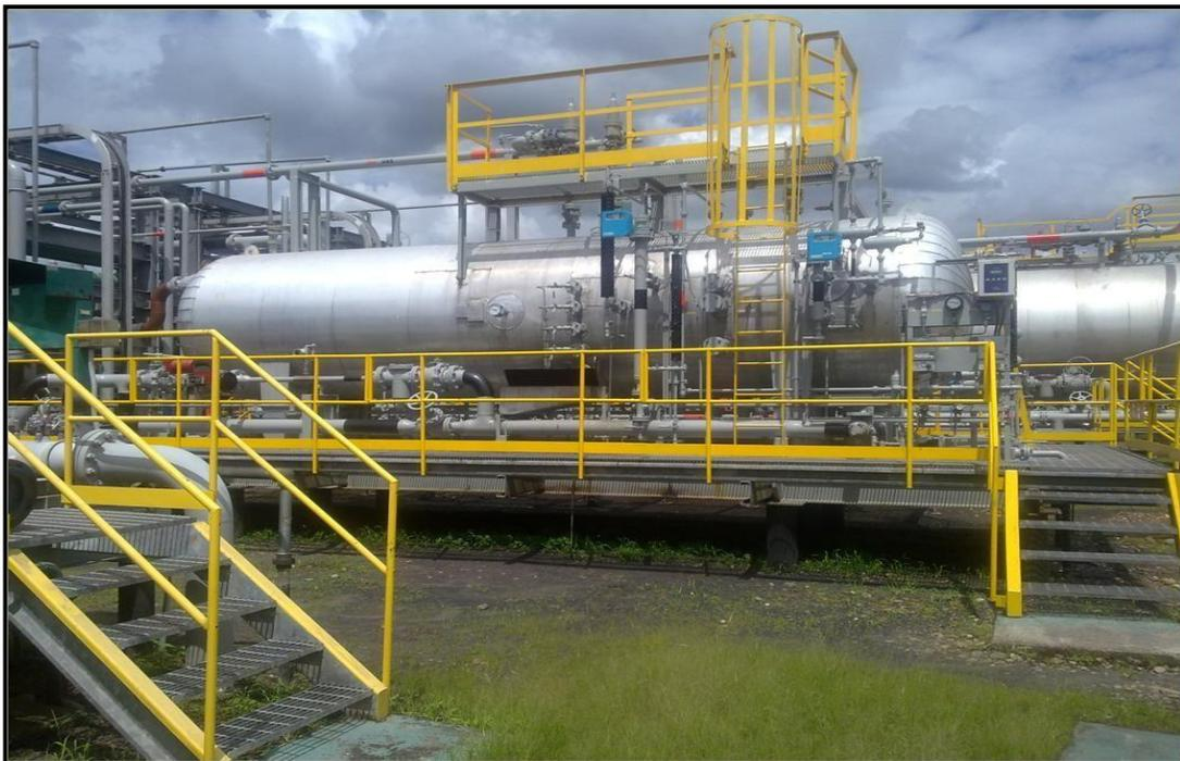
Figura 11. Separador de prueba convencional.
