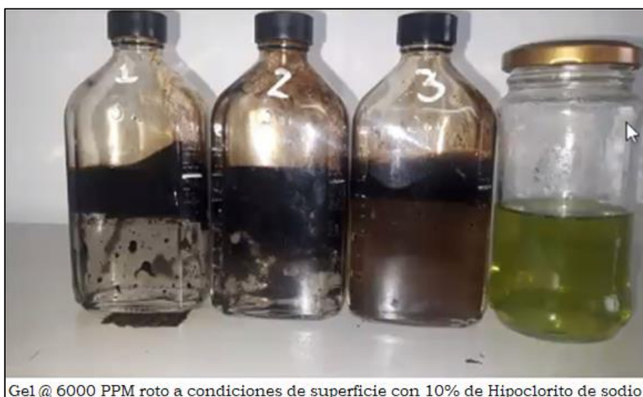
Figura 8. Prueba de rompimiento de gel de polímeros.
