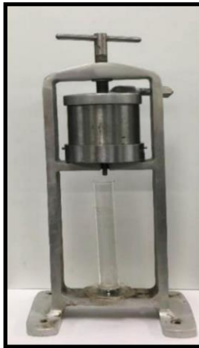
Figura 4: Celda de Filtrado
