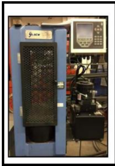
Figura 3: Unidad de prensa Hidráulica.
