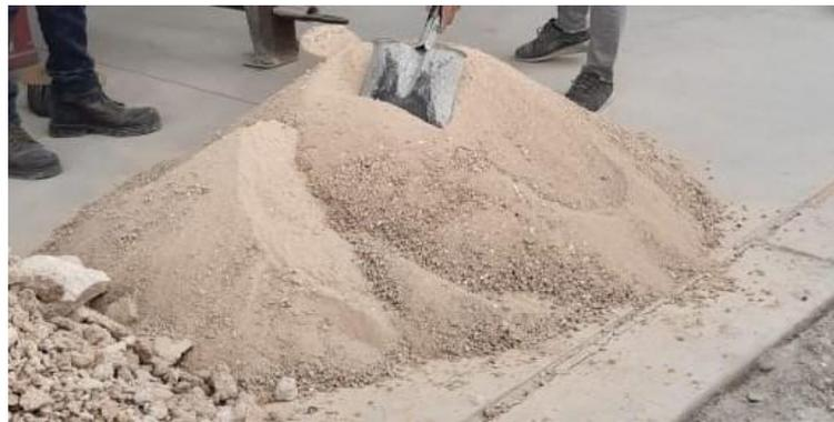
Nota. El gráfico representa una cantidad de agregado fino El Tablazo que se utilizó en la mezcla de hormigón.
