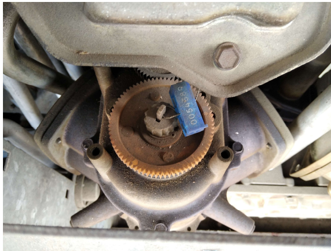
Figura 8. Unidad de medida con sello de seguridad Fuente: Estación de Servicio Ballenita
