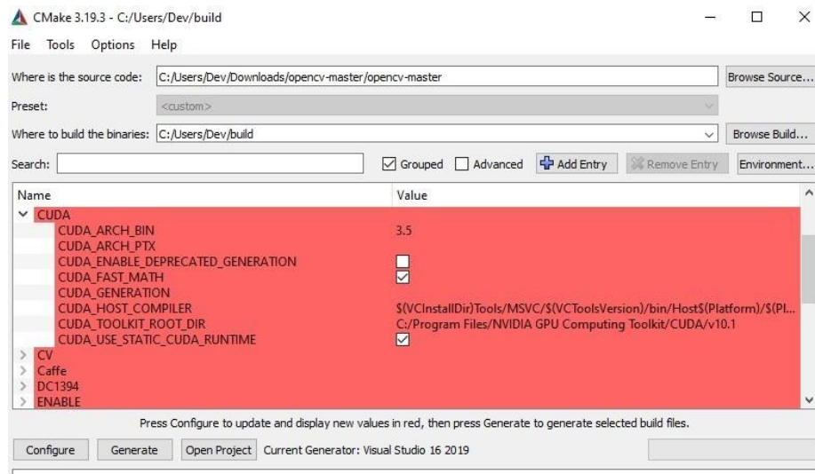
Fig. 22. Configuración CUDA para aceleración gráfica y análisis matemático
