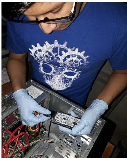
Figura 9: Proceso de extracción del Disco Duro
