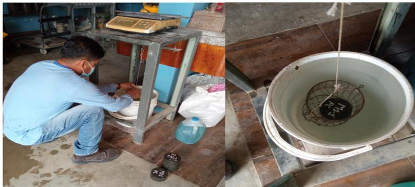
Para la determinación de la densidad Bulk se toman tres pesos: peso de la briqueta en el aire seco, peso al aire saturado superficialmente seco y peso en el agua saturado superficialmente seco, esto se lo realiza para todas las briquetas, luego se sumergió cada briqueta en una canastilla.
