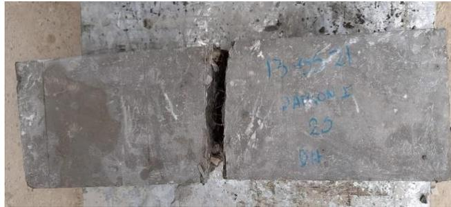
*Nota.* Imagen de viga de hormigón reforzada con fibra de coco
