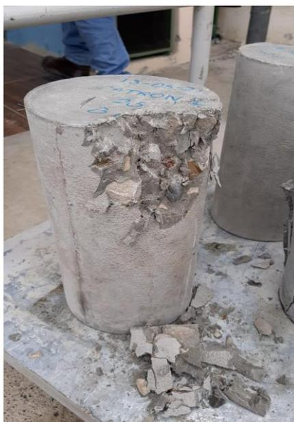
*Nota.* Figura representativa del ensayo de resistencia a la compresión.
