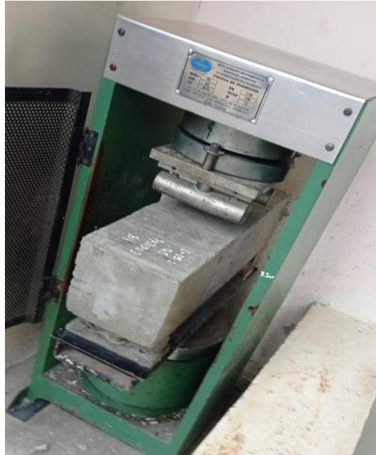
*Nota.* Figura representativa del ensayo de resistencia a flexión del hormigón
