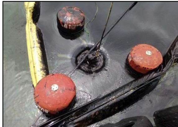
Figura 22: Skimmer recolectando hidrocarburo. (Fuente: Informe de derrame de crudo - EP PETROECUADOR).
