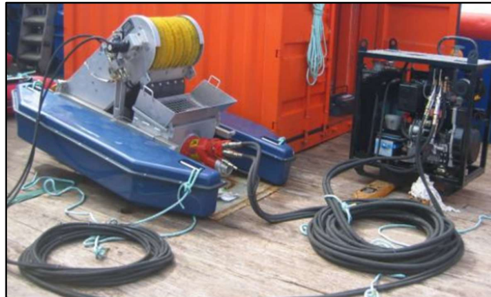
Figura 14: Skimmer tipo oleofilico (Fuente: Casado, 2013)
