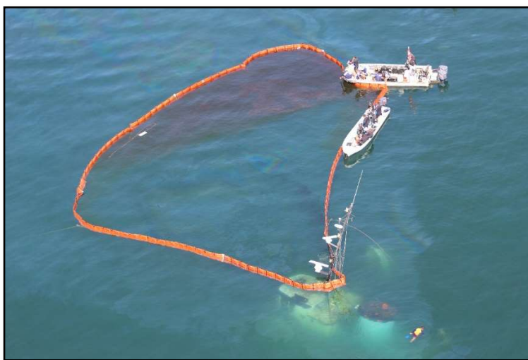
Figura 5: Contención y recuperación de hidrocarburos flotantes (Fuente: Diario Milenio).
