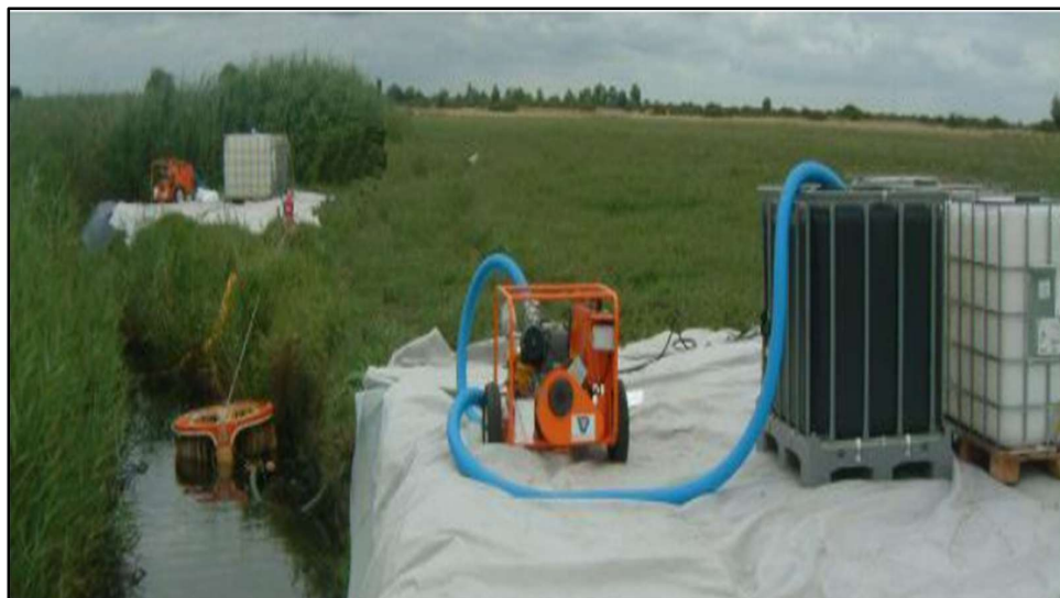
Figura 11: Conjunto skimmer, bomba de potencia y tanque de almacenamiento (Fuente: Casado, 2013). 22
