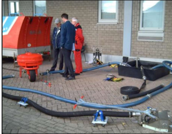
Figura 12: Skimmer de vacío (Fuente: Casado, 2013).
