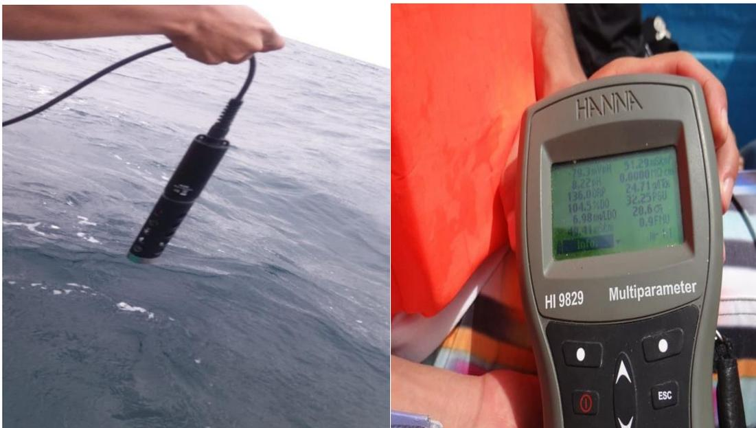
**Figura 15.** Registro de variables ambientales mediante YSI.
