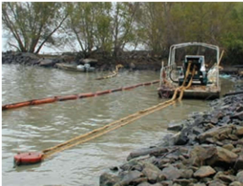
Figura 10. Skimmer oleofílicos. Fuente: (ITOPF, 2012).
