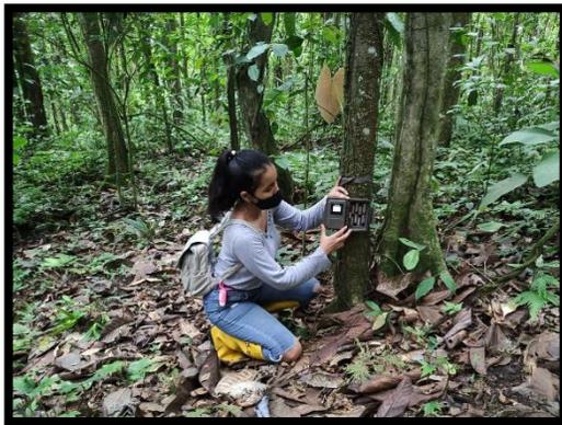
**Figura 12:** Instalación de cámara trampa.
