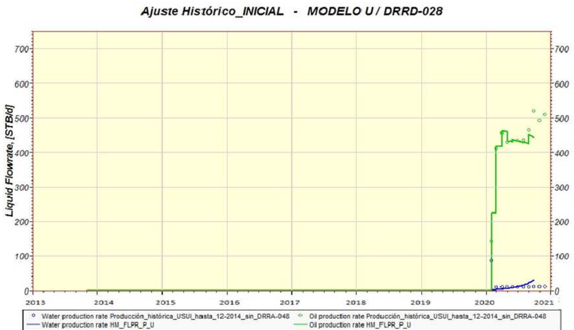
Fig. 147 Ajuste histórico Inicial modelo U DRRD-028 (verde: línea continua – modelo, puntos – historia) & agua (azul: línea continua – modelo, puntos, modelo, puntos historia) & agua (azul oscuro: línea continua)
