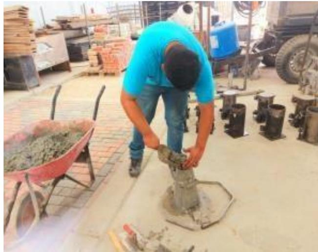
Nota: Ensayo de cono de Abrams de las muestras de hormigón
