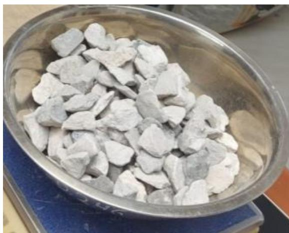
Nota: Agregado grueso utilizado en las mezclas de hormigón
