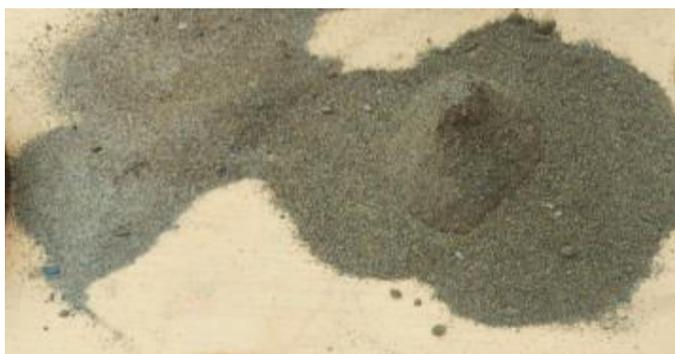
Nota: Agregado fino utilizado en las mezclas de hormigón
