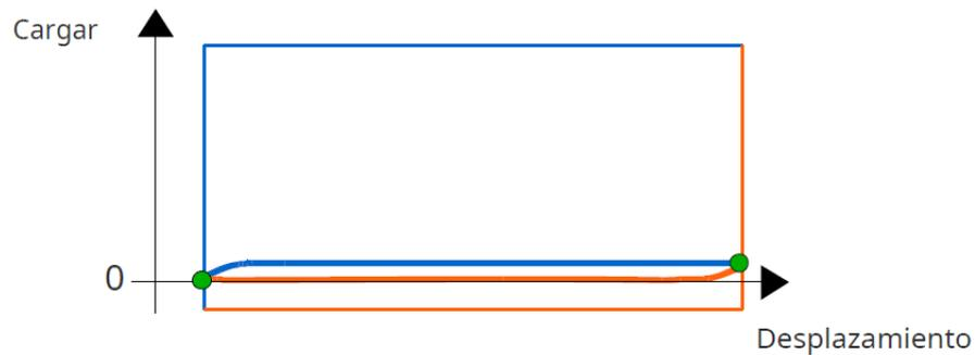
*Figura 9: Carta Dinamométrica por Bomba Desasentada*
