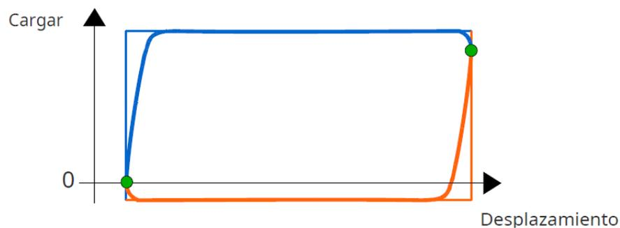
*Figura 8: Carta Dinamométrica por Bombeo Normal*
