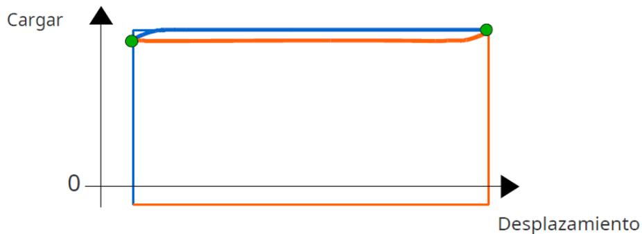
*Figura 15: Carta Dinamométrica por Válvula Fija Dañada*
