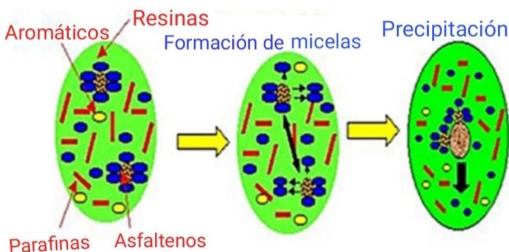
Figura 7. Proceso de floculación y precipitación de los asfáltenos (Borges, 2013).
