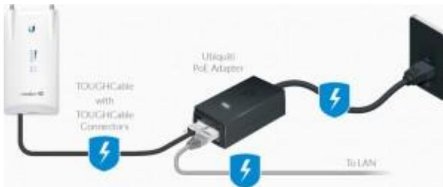
**Figura 41. Gráfico de conexión de antena locoM2.**
